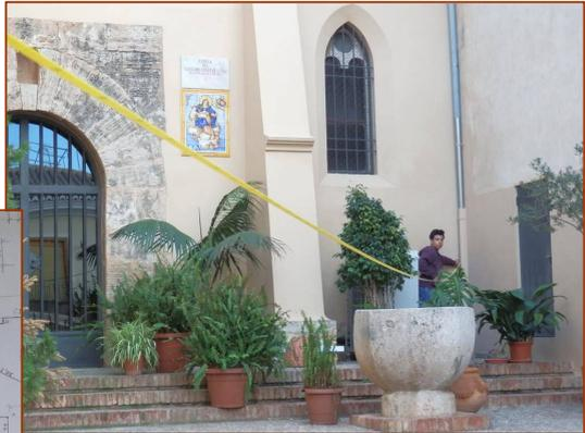
*Ilustración 25. Ejemplo de medición de largas distancias con cinta métrica.*
