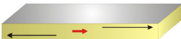
Figura 10. Vibración Cizalla, la flecha roja indica el vector de polarización de la cerámica y la flecha negra el modo de vibración.
