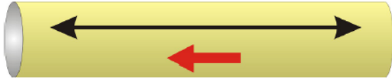
Figura 6. Vibración longitudinal, la flecha roja indica el vector de polarización de la cerámica y la flecha negra el modo de vibración.
