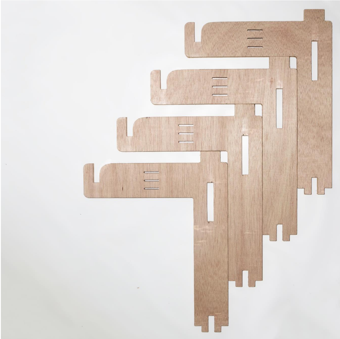
Figura 7.1:5 Patas situadas sucesivamente, de manera similar a cómo van a ser mecanizadas
