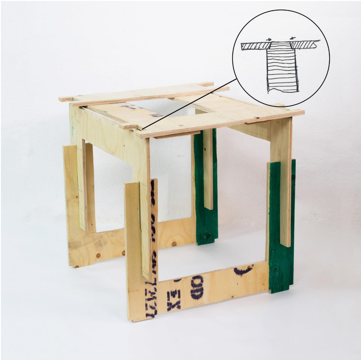
Figura 6.3:6 Prototipo para el testeo de la unión mediante apriete directo
