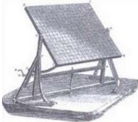
IMAGEN 2: “Mecanismo con 168 piezas de cristal diseñado por Buffon” Fuente: Tecnología solar, energías renovables
