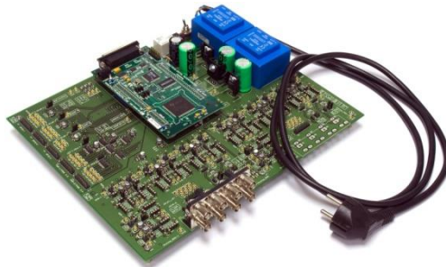
Figura 148: PCB GSEI de control de propósito general con DSP Texas Instruments Delfino TMS320F28335
