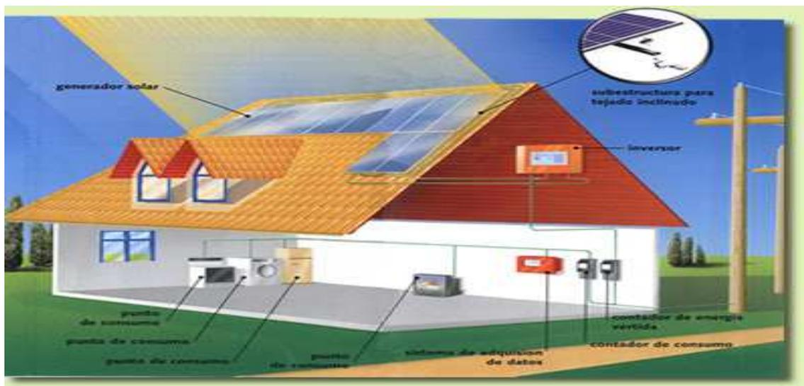
Figura 4 Instalación solar fotovoltaica sobre el tejado de una vivienda para la producción de energía eléctrica (Fuente: web 3)
