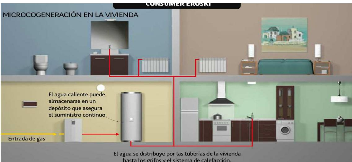
Figura 41...Para distribuirla por las tuberías de la vivienda hasta los grifos y el sistema de calefacción, Fuente: (web 10)
