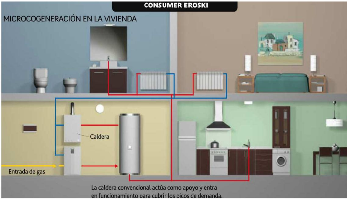
**Figura 43...Puede instalarse una caldera convencional que actúe como apoyo y entre en funcionamiento para cubrir los picos de la demanda, Fuente: (web 10)**
