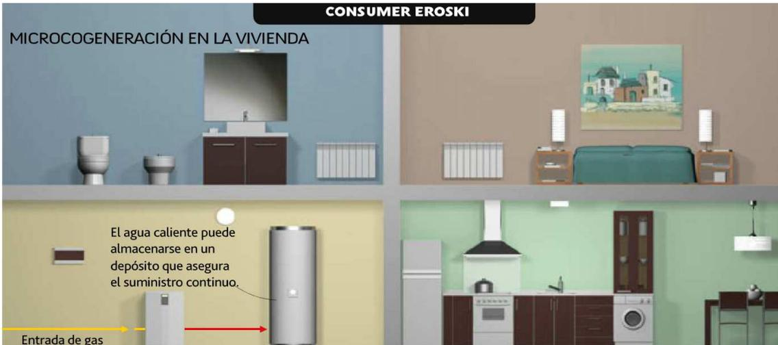
Figura 40..., se almacena el agua caliente en un depósito, Fuente: (web 10)
