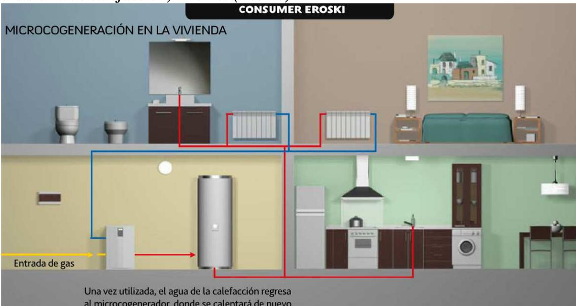
Figura 42...Una vez utilizada, el agua de la calefacción regresa al microgenerador, donde se calentará de nuevo, Fuente: (web 10)
