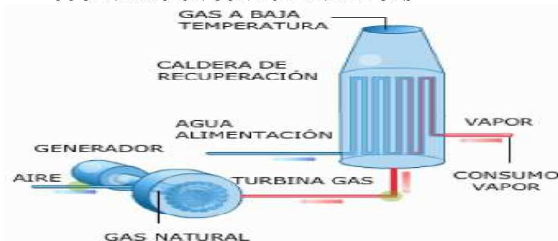
**Figura 14 (Cogeneración, con turbina de gas); (web 8)**
