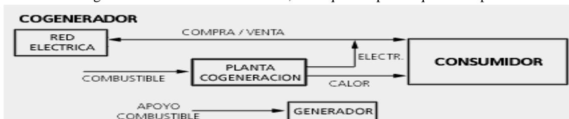
**Figura 10** Esquema de la cogeneración a vista de pájaro (Fuente: web 6)
