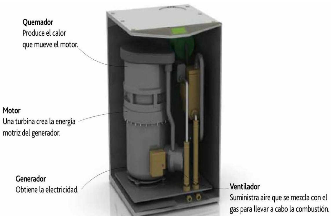
Figura 31 ..., ..., generador y ventilador de un micro-cogenerador, fuente: (web 10)
