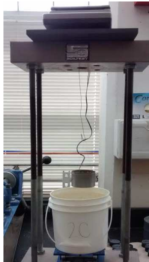
Imagen 6.2.1.1. Fotografía de la medición de los valores necesarios para calcular la gravedad específica
