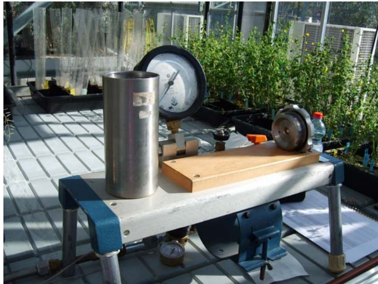
Foto 4: Cámara de Scholander utilizada para la determinación del potencial hídrico.
