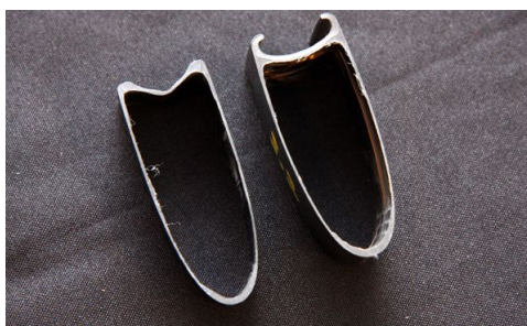
Figura 4.5: Sección de aro de Tubular (izq.) y Cubierta (drc.) (Fuente: Bikeradar).
