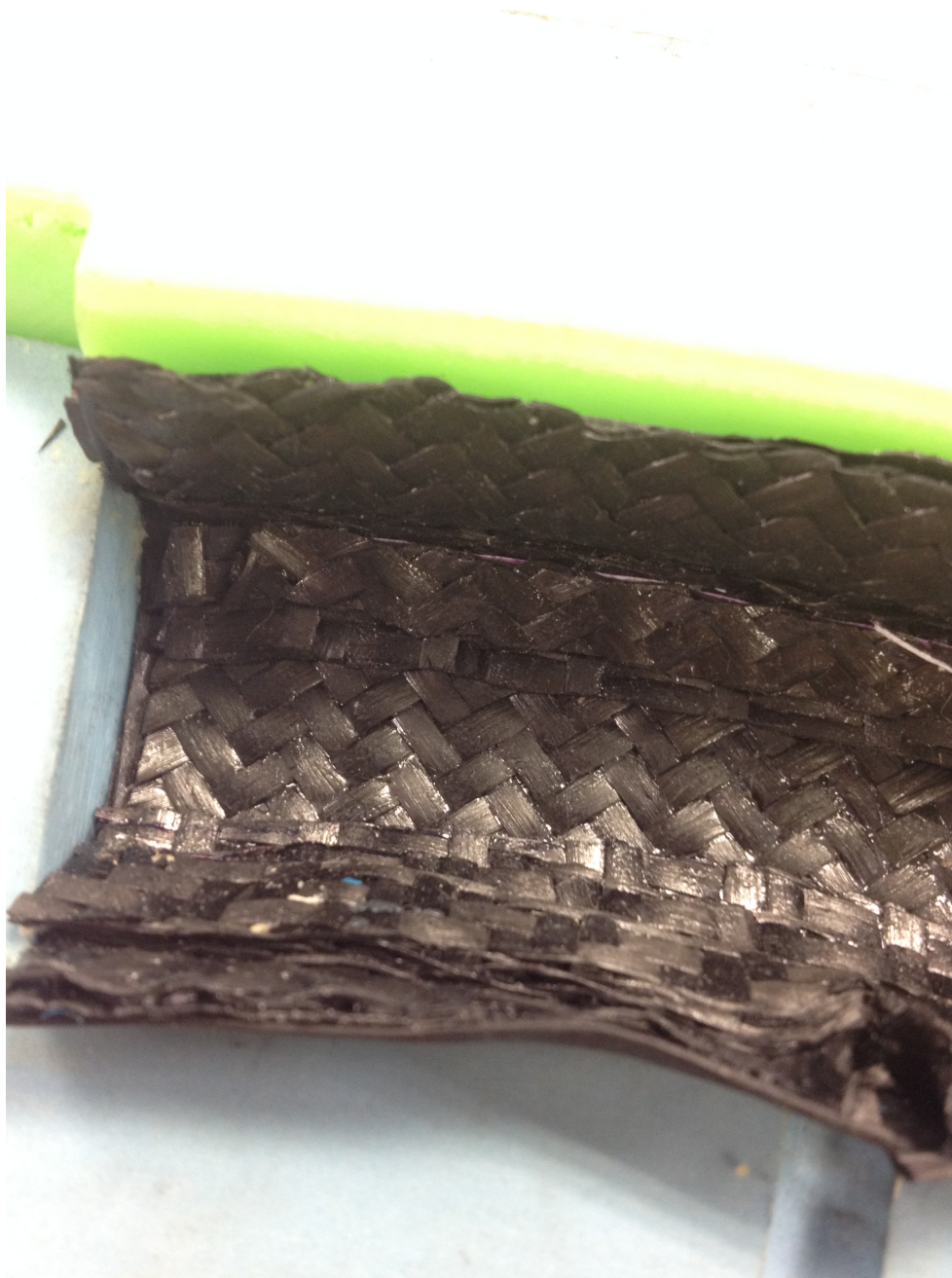
Figura 11.112: Laminado. Resultado una vez finalizado el proceso de laminación. (Fuente: Propia)
