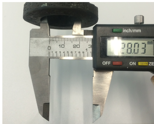
Figura 11.76: Ensamblaje. Diámetro interior de la pared del buje. (Fuente: Propia)
