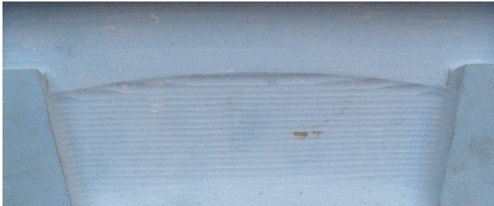
Figura 11.97: Preparación del Molde. Diferencia entre la parte lijada del molde y la que no lo ha sido. (Fuente: Propia)
