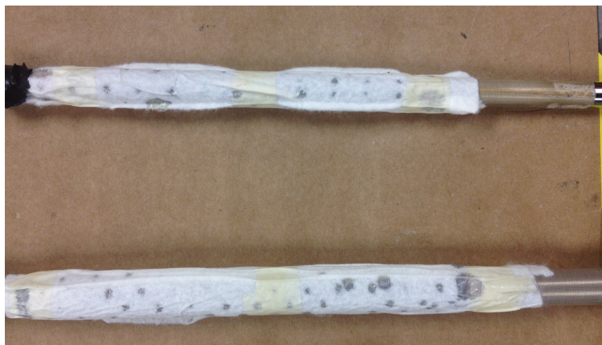
Figura 11.29: Experimento 1. Residuos de resina en ambos tubos (Fuente: Propia)
