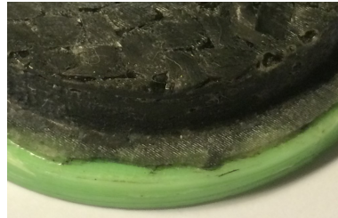
Figura 11.71: Desmoldeo buje. Detalle del exceso de material acumulado. (Fuente: Propia)
