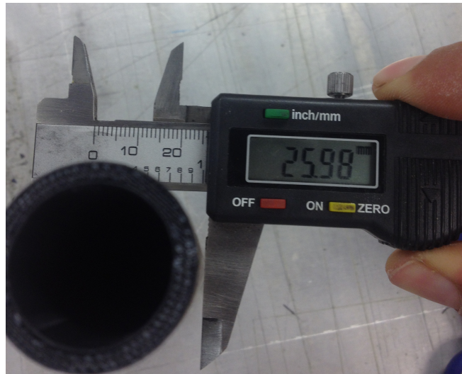
Figura 11.39: Experimento 3. Diámetro externo del molde con una capa de teflón. (Fuente: Propia)
