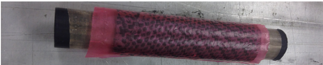
Figura 11.40: Experimento 3. Instalación de la malla de guiado I. (Fuente: Propia)
