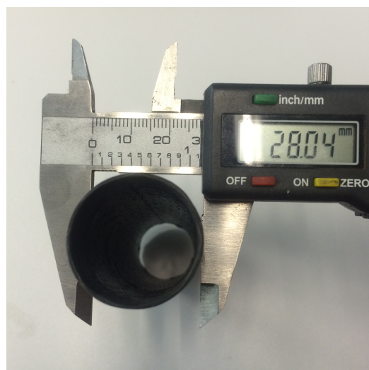
Figura 11.75: Ensamblaje. Diámetro exterior del tubo fabricado y rectificado. (Fuente: Propia)
