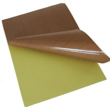
Figura 11.3: Teflón utilizado para facilitar el desmoldeo (Fuente: tudiras.com)
