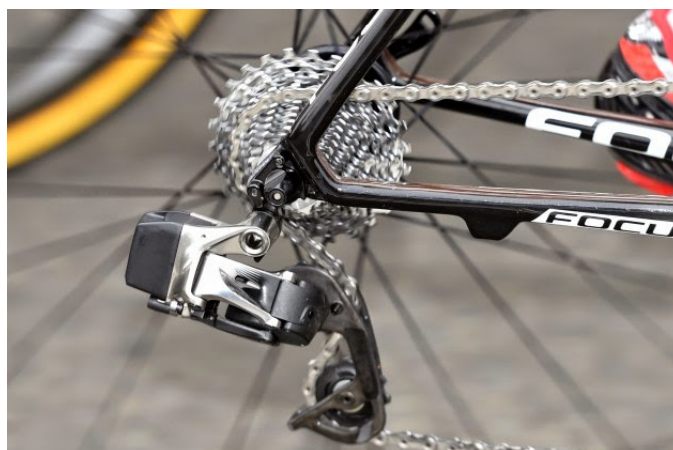
Figura 1.4: Cambio inalámbrico Sram. (Fuente: Top5bicis)
