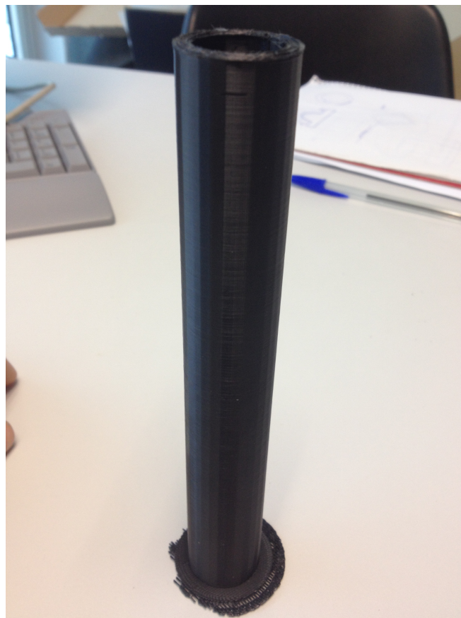
Figura 11.36: Experimento 3. Tubo realizado mediante impresión 3D. (Fuente: Propia)
