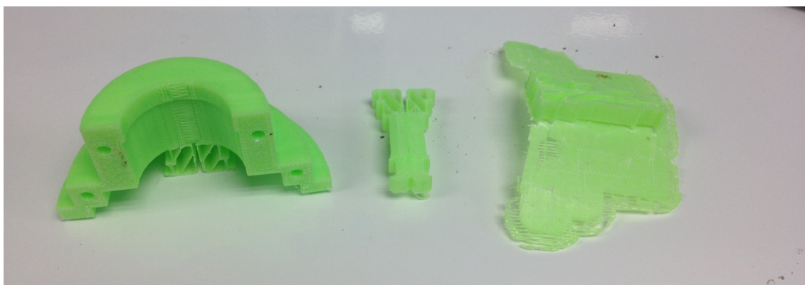
Figura 11.60: Preparación del Molde. Sustracción del soporte inferior y los realizados para poder fabricar en condiciones la pieza. (Fuente: Propia)
