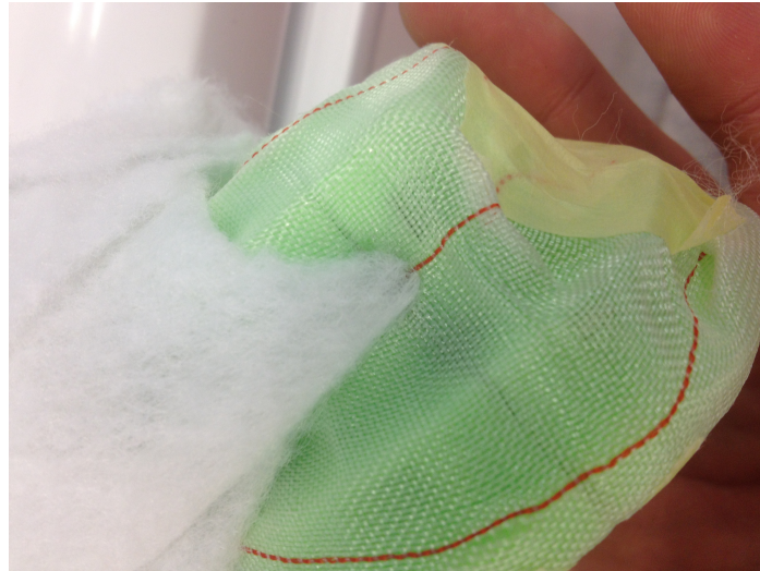
Figura 11.67: Desmoldeo buje. Restos de resina sobre la malla de guiado II y la manta de absorción. (Fuente: Propia)
