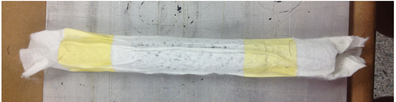
Figura 11.47: Experimento 5. Restos de resina en la manta de absorción. (Fuente: Propia)
