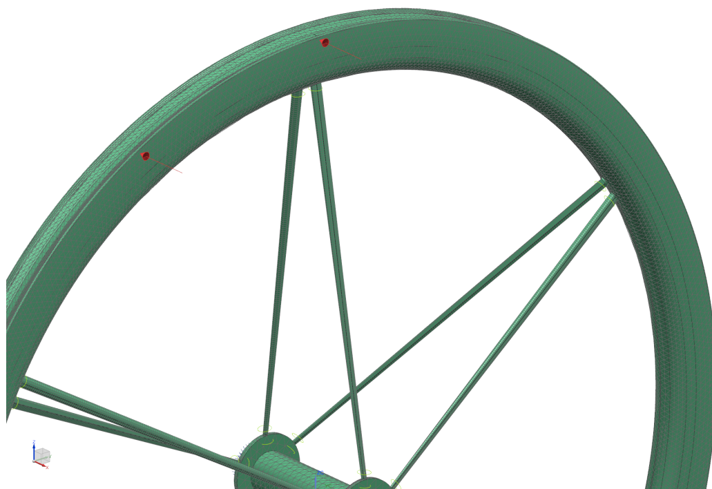
Figura 8.5: Posición de aplicación de las fuerzas sobre los nodos de la malla que definen la rueda. (Caso II (Izq.) y Caso I (Drc.)) (Fuente: Propia)
