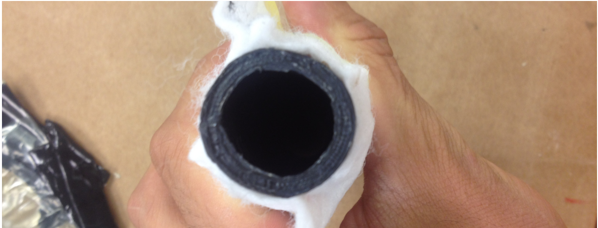
Figura 11.46: Experimento 3. Después del proceso de curado el molde deja de tener una sección circular. (Fuente: Propia)
