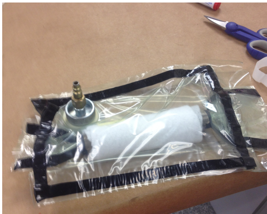
Figura 11.43: Experimento 3. Bolsa de vacío con un compartimento que realiza el vacío sobre las dos caras del molde. (Fuente: Propia)
