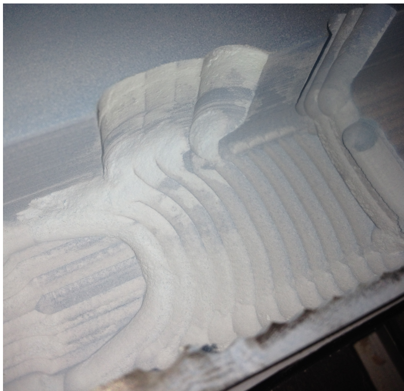
Figura 11.104: Experimento 1. Estado del tocho después de que el cabezal golpee los límites del tocho. (Fuente: Propia)
