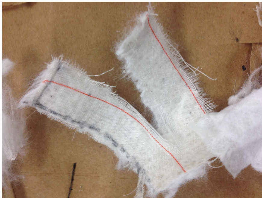
Figura 11.48: Experimento 5. Restos de resina en la malla de guiado II. (Fuente: Propia)
