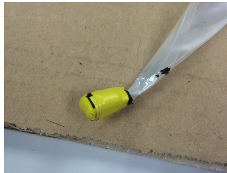
Figura 11.116: Bolsa de Aire. Colocación de la bolsa en la parte externa del molde. (Fuente: Propia)
