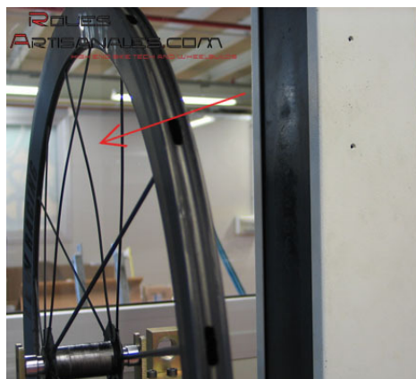
Figura 5.7: Test de rigidez frontal sobre unas ruedas Reynolds RZR (Fuente: Roues Artisanales )
