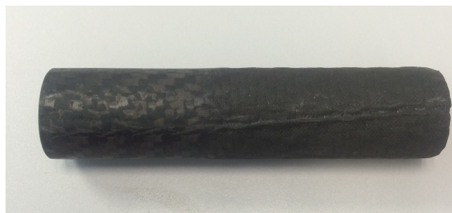
Figura 11.50: Experimento 5. Resultado del tubo después del lijado para eliminar las imperfecciones. (Fuente: Propia)
