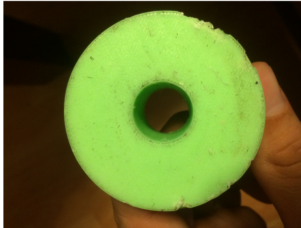
Figura 11.69: Desmoldeo buje. Estado del molde después del curado. (Fuente: Propia)
