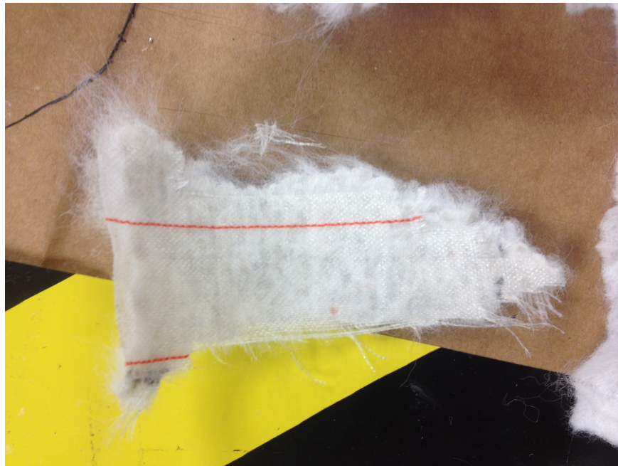
Figura 11.49: Experimento 5. Restos de resina en la malla de guiado II. (Fuente: Propia)
