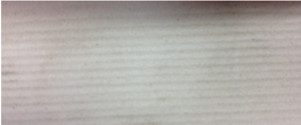
Figura 11.85: Experimento 1. Detalle de la cantidad de crestas dejadas durante la operación. (Fuente: Propia)
