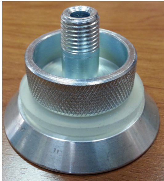
Figura 11.10: Toma de Vacío (Fuente: Propia)
