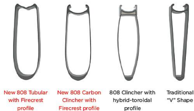
Figura 5.2: Evolución del perfil del aro (Fuente: Jameson King)
