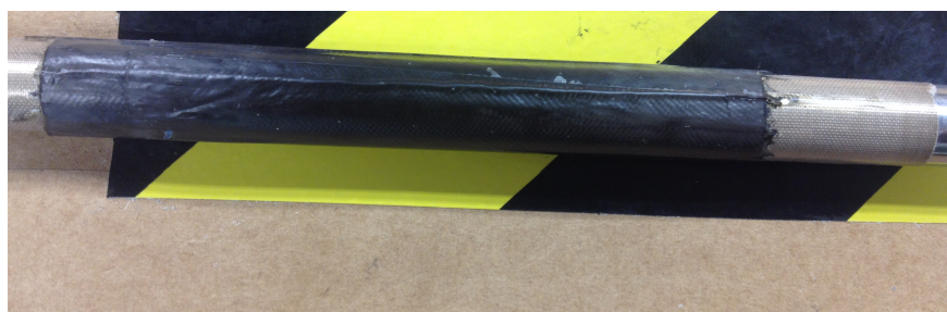
Figura 11.34: Experimento 2. Resultado del tubo de carbono fabricado con fibra unidireccional. (Fuente: Propia)
