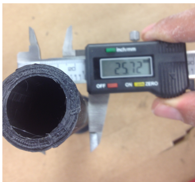
Figura 11.38: Experimento 3. Diámetro externo del molde inicial. (Fuente: Propia)
