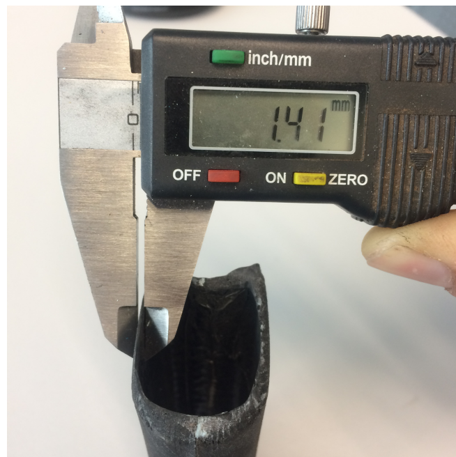
Figura 11.127: Fabricación II. Espesor de la pared vertical del aro. (Fuente: Propia)
