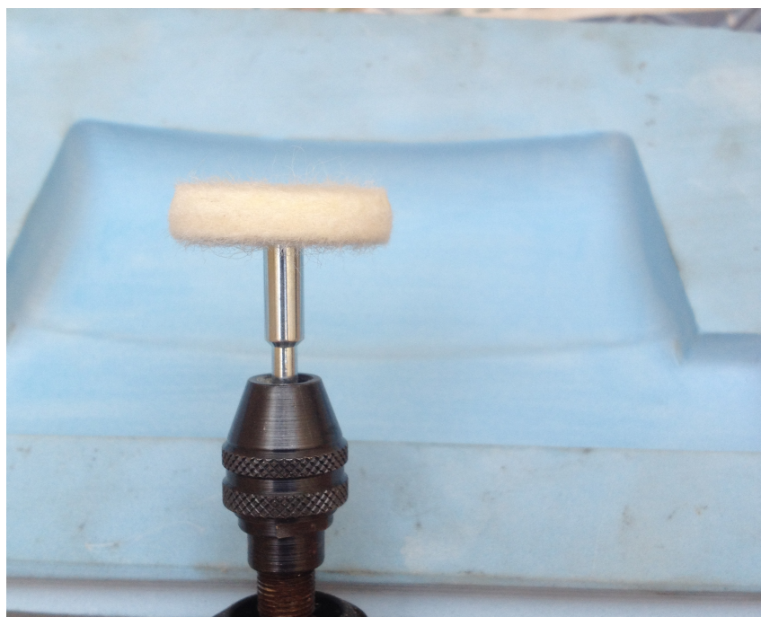
Figura 11.98: Preparación del Molde. Disco especial para pulido. (Fuente: Propia)
