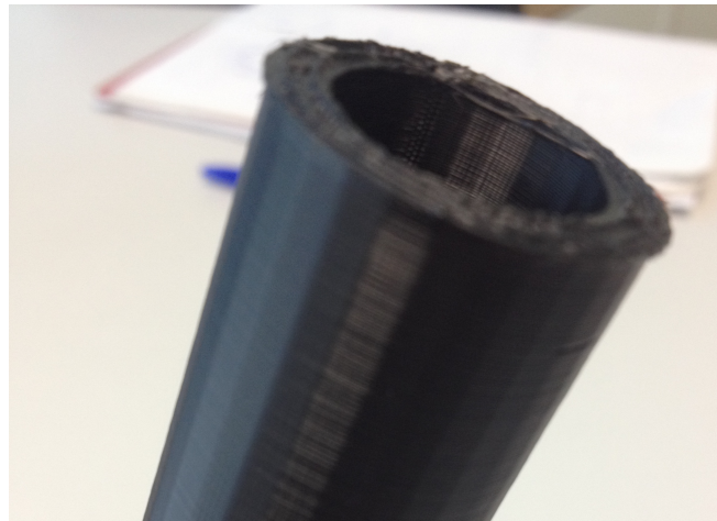
Figura 11.37: Experimento 3. Detalle de la superficie del tubo realizado mediante impresión 3D. (Fuente: Propia)
