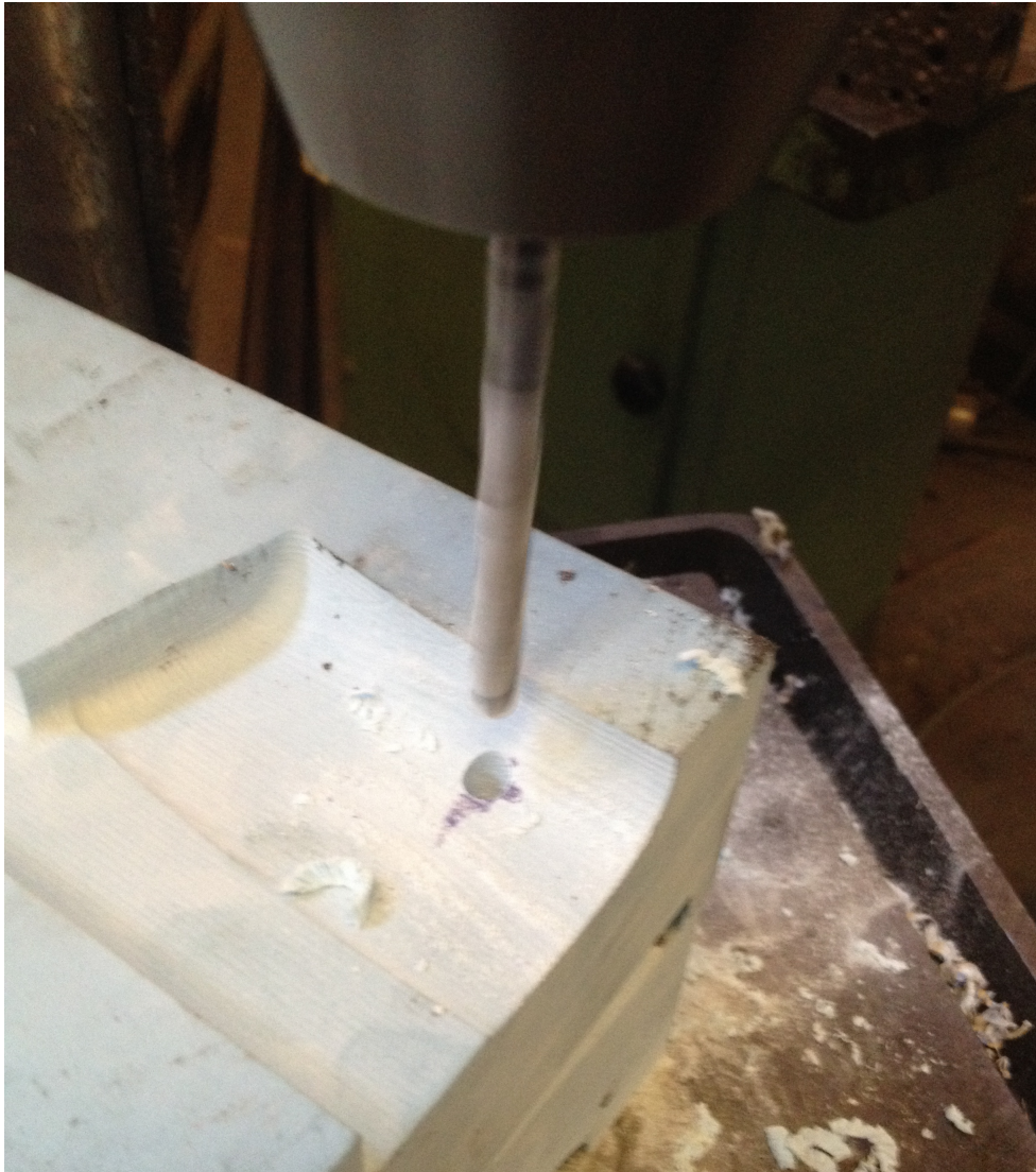
Figura 11.96: Preparación del Molde. Realización de los agujeros para poder dejar fijados las dos partes. (Fuente: Propia)
