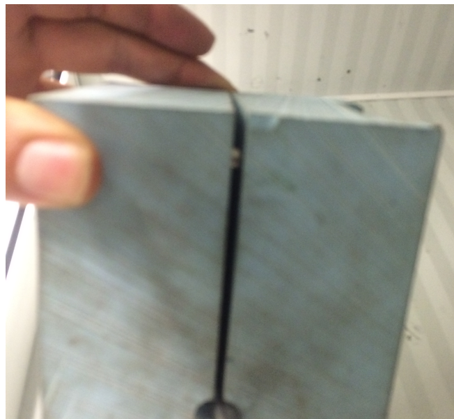
Figura 11.117: Fabricación I. Molde abierto debido a la excesiva presión. (Fuente: Propia)
