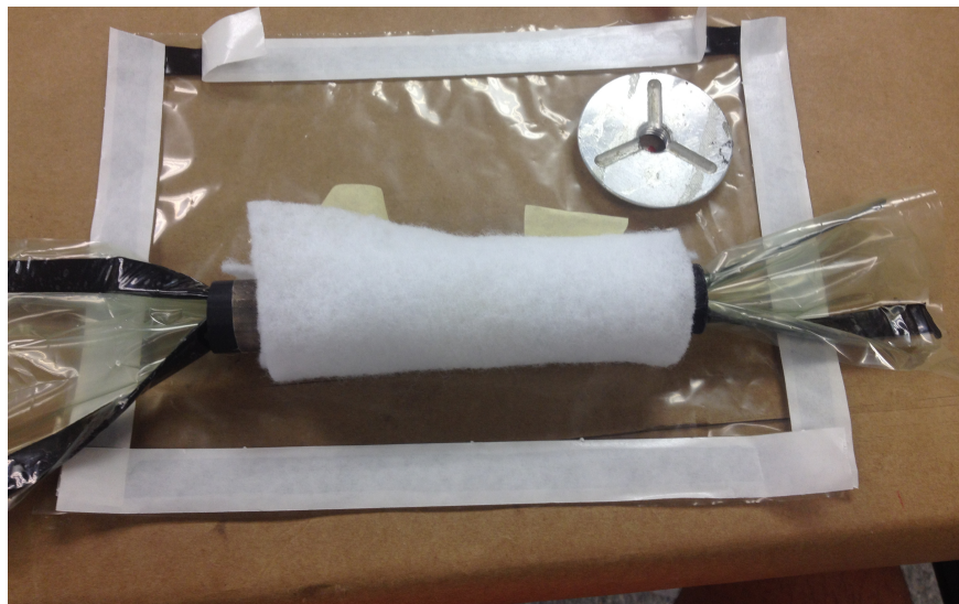
Figura 11.42: Experimento 3. Preparación de la bolsa de vacío. (Fuente: Propia)
