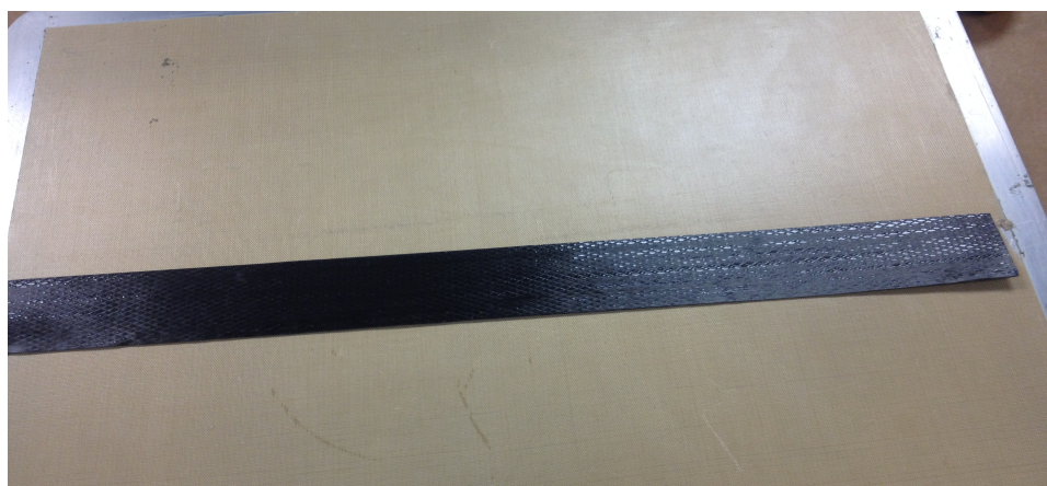
Figura 11.13: Placa de fibra de carbono para el radio sin laminar (Fuente: Propia)
