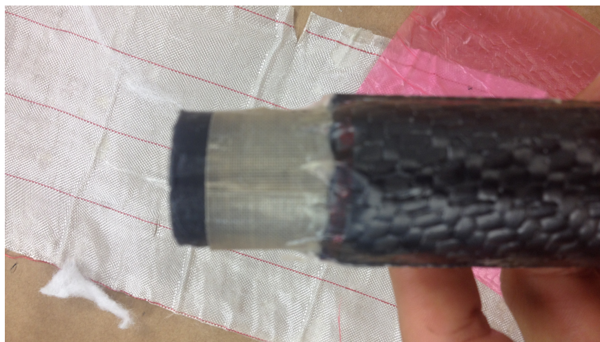
Figura 11.45: Experimento 3. Exceso de resina en la unión del tubo de carbono y el molde. (Fuente: Propia)
