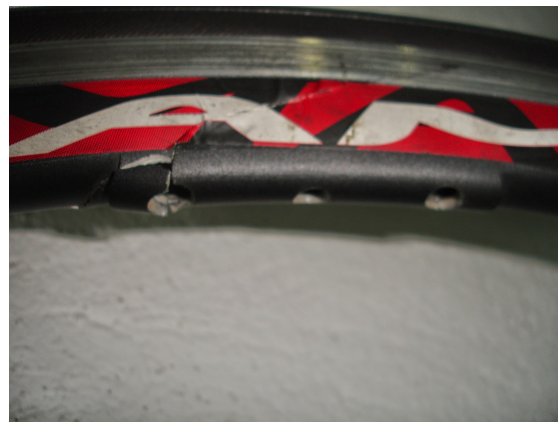
(b) Rotura unión radio-aro
