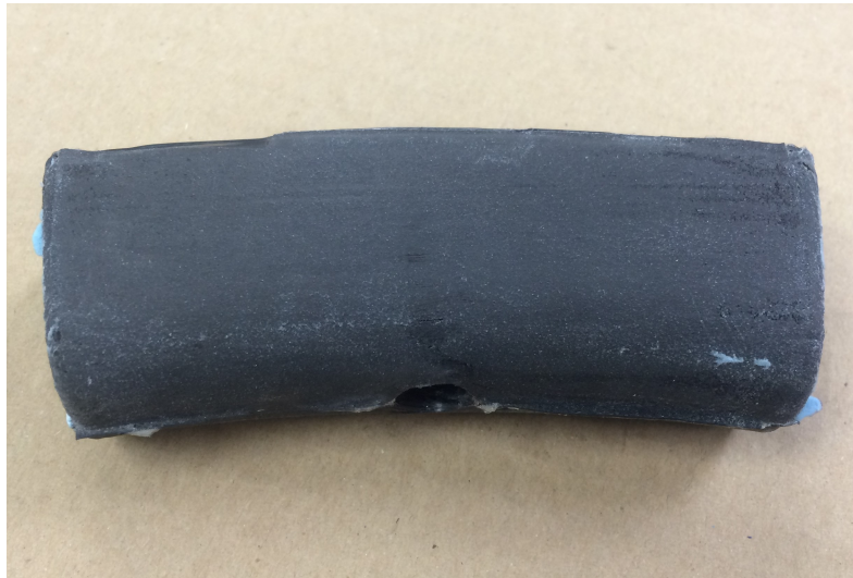
Figura 11.122: Fabricación II. Resultado del aro tras el curado [Vista Isométrica]. (Fuente: Propia)
