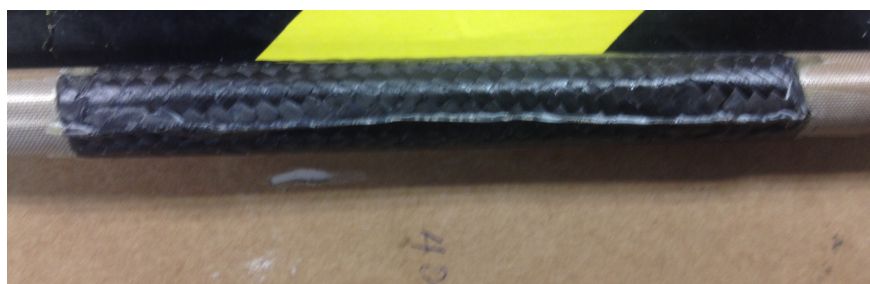
Figura 11.35: Experimento 2. Resultado del tubo de carbono fabricado con fibra 0-90°. (Fuente: Propia)
