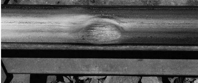
Figura 2.11. Patinaje en la superficie de rodadura del carril.
