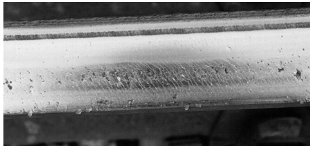
Figura 2.15. Grietas de fatiga de contacto de rodadura con pequeños desconchados en la superficie de rodadura del carril ( Head checks y spalling ).
