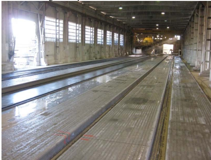
Figura 3-9 Pista de fabricación de placas alveolares (Imagen cedida por HORVITEN VALENCIA, S.A).
