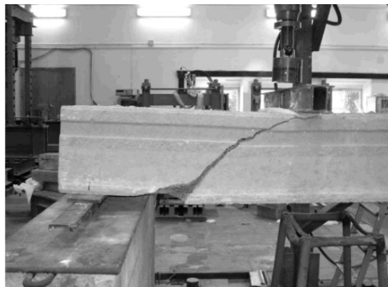
Figura 6-34. Rotura por cortante en el apoyo.
