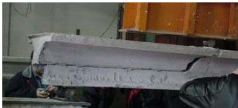
Figura 6-42. Rotura por rasante de una vigueta.
