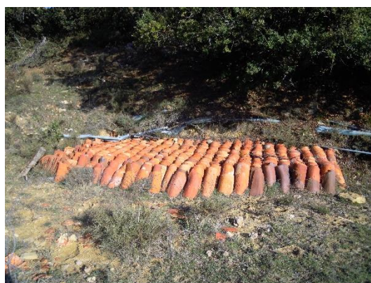
Figura 94 - Acopio de teja curva extraída de las ruinas de un edificio. Fuente: Propia.
