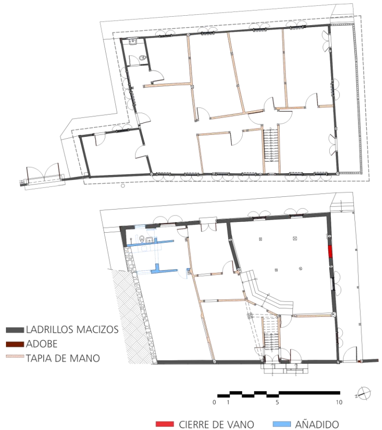
Fig. 74. Substitución del adobe por ladrillos en la fachada
