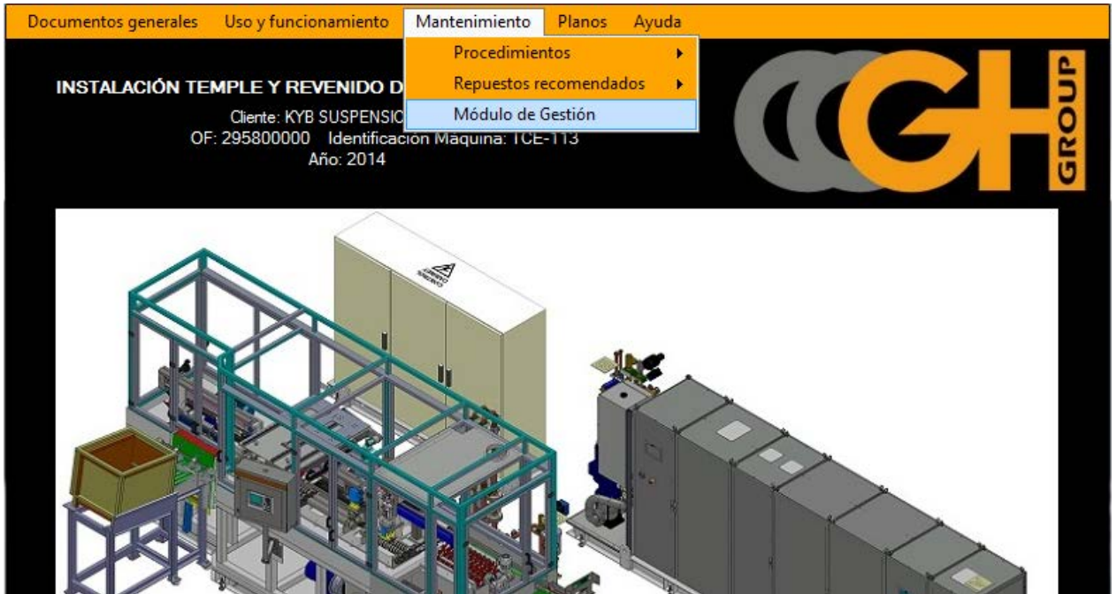
Figura 11: Acceso al Gestor de Mantenimiento desde la pantalla principal
