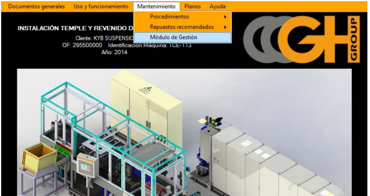
Figura 8: Acceso al Gestor de Mantenimiento desde la pantalla principal
