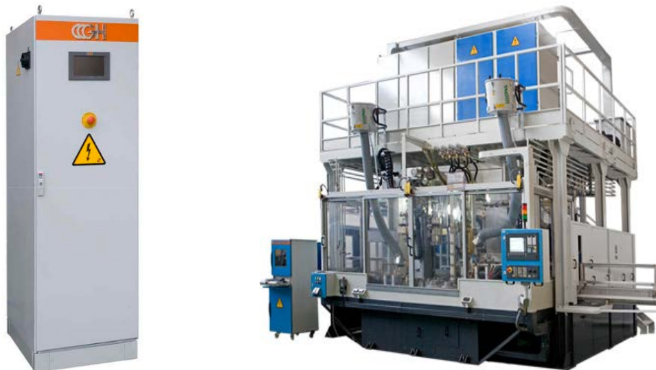
Figura 2: Generador de inducción (izquierda); instalación de inducción (derecha) (GH Induction, 2011)
