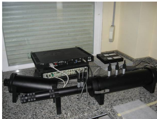
Figura 2. Detalle del equipo utilizado en la caracterización acústica de los diferentes materiales.
