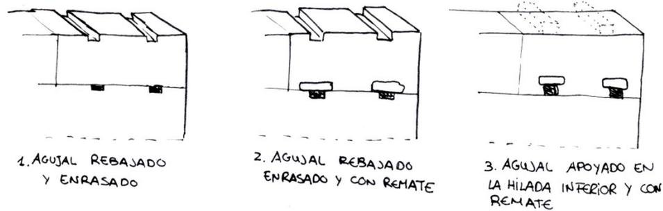
Img. 4. 8 Esquema disposición de las agujas
