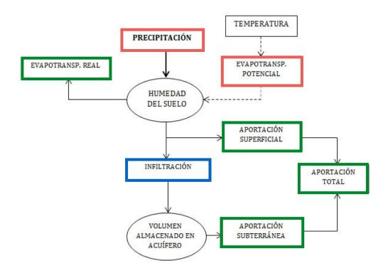
Figura 15: Esquema conceptual del Modelo Hidrológico Agregado Témez.
