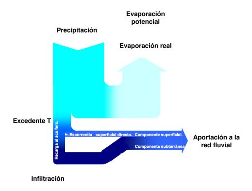
Figura 20: Esquema para representar el balance ciclo hidrológico.
