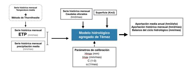
Figura 18: Esquema metodológico de la calibración del Modelo Agregado de Témez.
