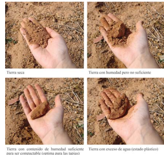
Figura 3.11. Imagen de diferentes grados de humedad de la tierra, pruebas de campo.
