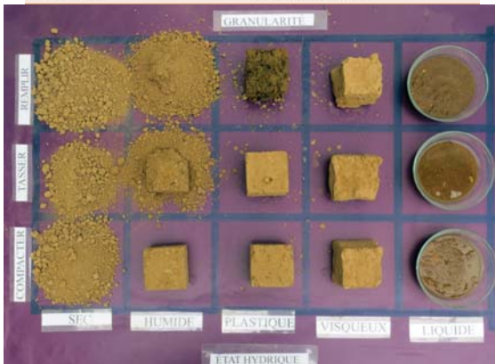
Figura 3.10. Sup: Tabla de clasificación de los granos. Inf: Experimentación del comportamiento de diversas tierras frente al agua durante los talleres del Festival Grains d'Isère. Le Grands Ateliers. Villefontaine (Francia).
