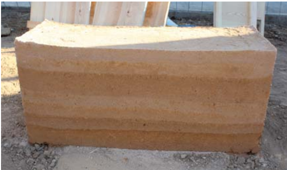
Figura 3.13. Imagen de la variación de color en las diversas tongadas en la realización de una tapia.
