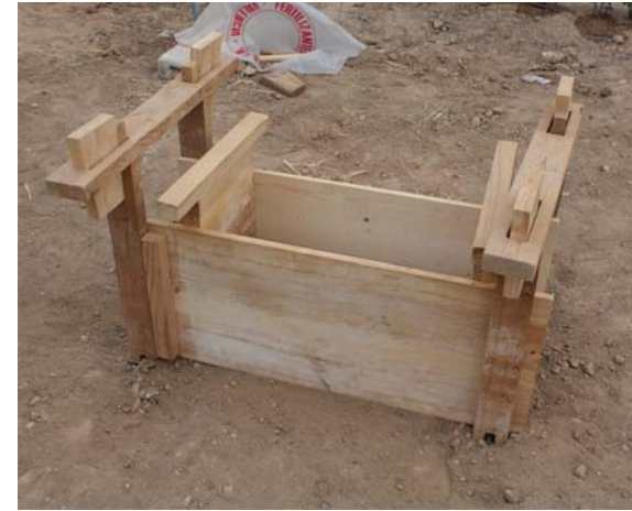
Figura 3.14. Imagen de un tapial de madera de escala reducida para la realización de prácticas de campo.
