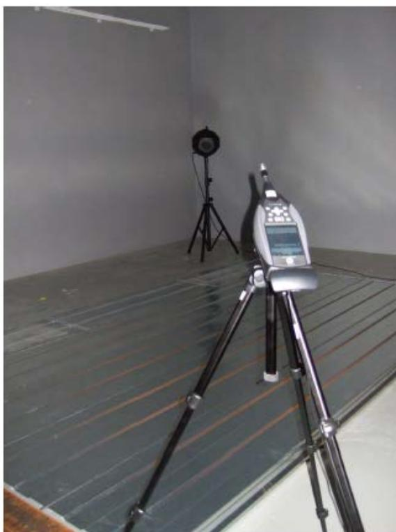
Imagen de la configuración ensayada en cámara reverberante
