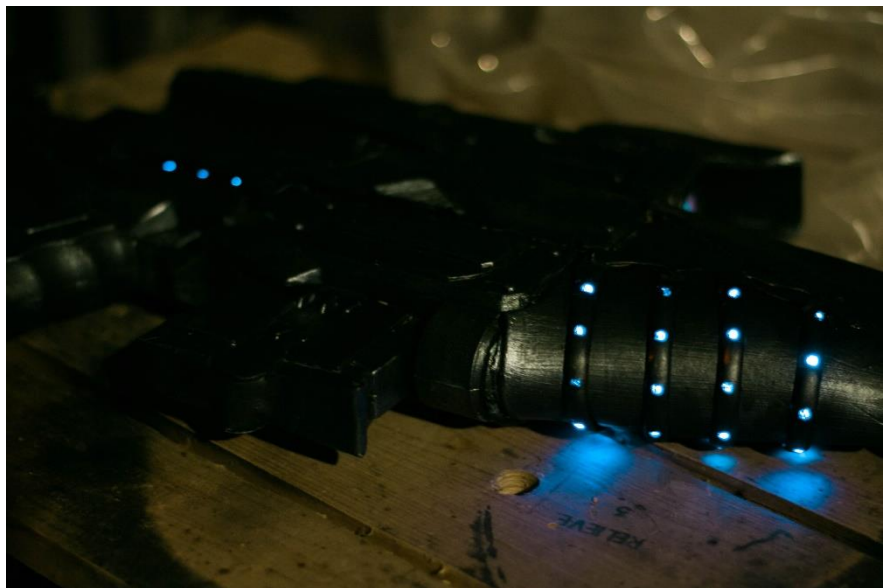
En ambas fotos podemos apreciar en sistema de iluminación creado a partir de tira de led con recubrimiento que inserté en varias zonas del rifle. Posee además un que led que crea un punto a bastante distancia y realiza su función como puntero.
