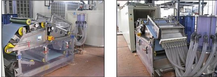
Figura III. 2.32.- Planta piloto de wet-laid de AITEX (PILL NASSVLIESTECHNIK GmbH, Alemania).
