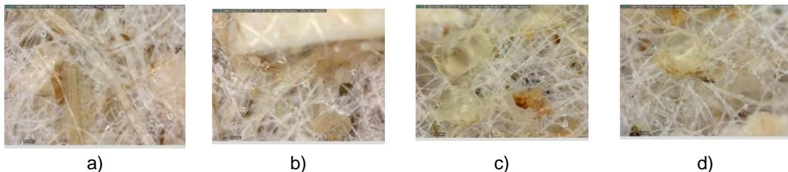
**Figura IV. 4.6.-** Imágenes obtenidas del microscopio óptico a 200 aumentos de los diferentes no tejidos. a) Alg \_30PI/oreg después del rociado; b) Alg \_15CO/oreg antes del rociado; c) Alg \_15CO/oreg después del rociado; d) Alg \_30PI/oreg después del rociado
