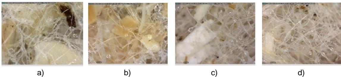
**Figura IV. 4.2.-** Imágenes obtenidas del microscopio óptico a 200 aumentos de los diferentes no tejidos. a) Chi\_15CO/oreg antes del rociado; b) Chi\_15CO/oreg después del rociado; c) Chi\_30PI/oreg antes del rociado; d) Chi\_30PI/oreg después del rociado
