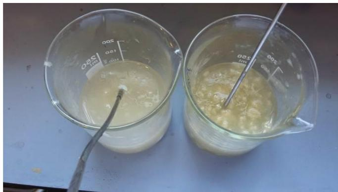
**Figura III. 3.2.-** Microcápsulas obtenidas por co-extrusión.
