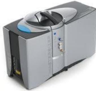
**Figura III. 2.22.- Mastersizer 3000 E en AITEX**
