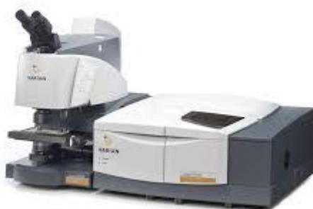
**Figura III. 2.26.-** Espectrofotómetro VARIAN FT-IR 670
