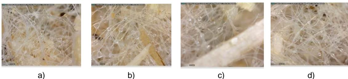
**Figura IV. 4.4.-** Imágenes obtenidas del microscopio de los diferentes no tejidos: a) Chi\_15CO/ sal antes del rociado; b) Chi\_15CO/ sal después del rociado; c) Chi\_30PI/ sal antes del rociado; d) Chi\_30PI/ sal después del rociado
