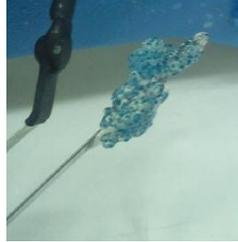
**Figura IV. 1.1.-** Electrodo con acumulación de microcápsulas.
