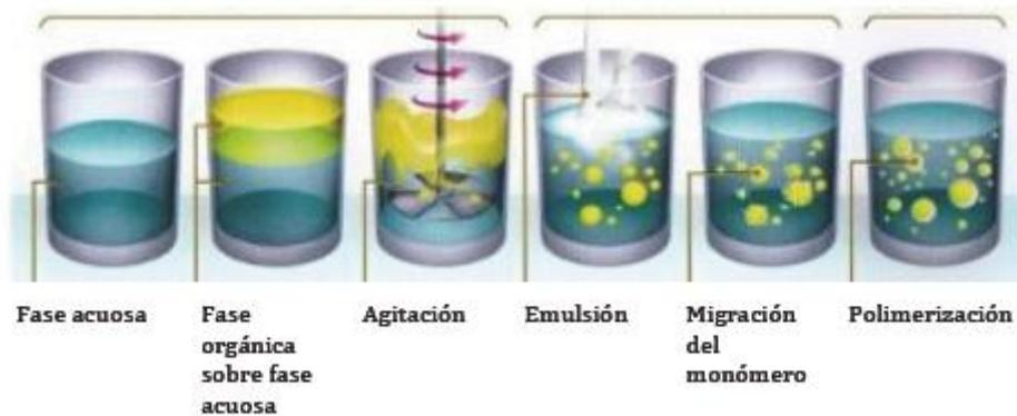
**Figura. I. 1.7.-** Proceso de Polimerización interfacial
