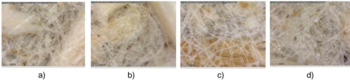
**Figura IV. 4.8.-** Imágenes obtenidas del microscopio óptico a 200 aumentos de los diferentes no tejidos. a) Alg\_15CO/ sal antes del rociado; b) Alg\_15CO/ sal después del rociado; c) Alg\_30PI/ sal antes del rociado; d) Alg\_30PI/ sal después del rociado
