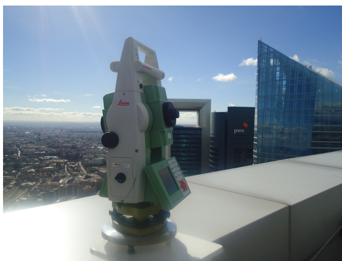
Figura 6.19: Observación con Estación Total robotizada sobre el vértice 2 en Torre Espacio (Fuente: propia)
