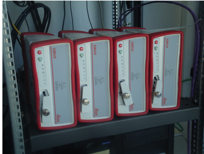
Figura 6.25: Detalle de los 4 receptores GM10 de Leica situados en la planta 55 de Torre Espacio (Fuente: propia)
