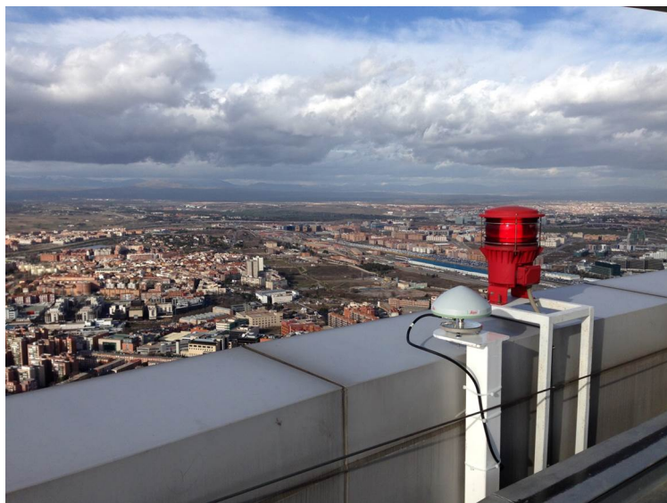
Figura 6.24: Antena GNSS 4 sobre pilar metálico en la azotea de Torre Espacio (Fuente: propia)
