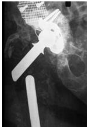
Imagen 9. Radiografía de una prótesis fallada por fatiga
