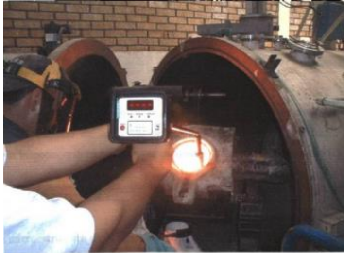
Imagen 77. Horno de inducción con cámara de vacío
