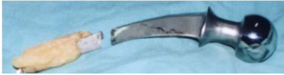
Imagen 14. Prótesis de cadera de Acero AISI 316L fallado por fatiga
