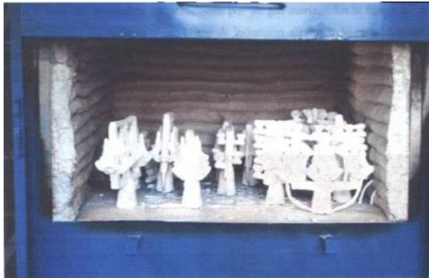
Imagen 75. Horno de sinterizado con árboles de colada en su interior
