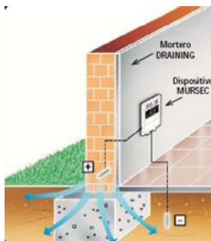
Ilustración 78. Sistema de electro-osmosis activa.
