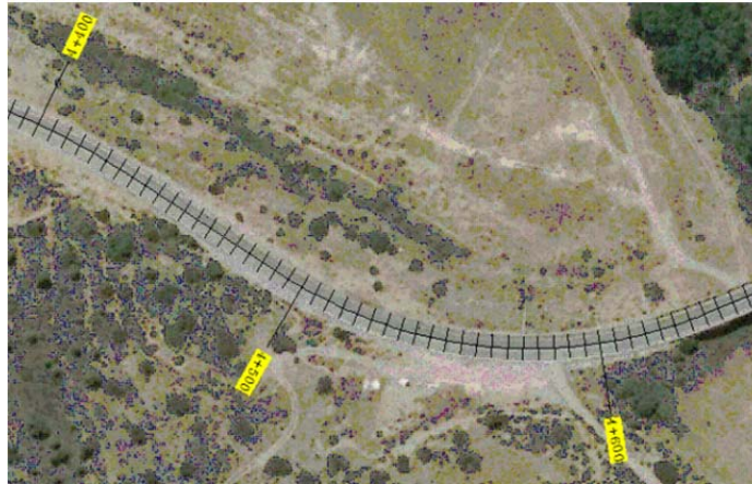
Figura 90: Restitución geométrica del eje con ubicación de marcas fijas referencia de perfiles transversales cada 5,0 m (carretera CV35)
