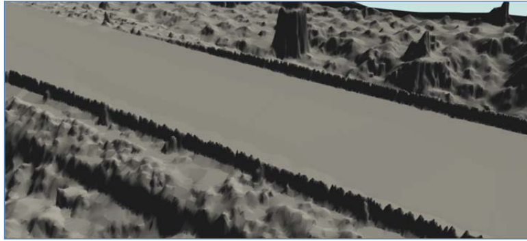
Figura 161: Carretera CV-35. Detalle alcanzado en el modelo tridimensional generado a partir del MDS donde se aprecia el abatimiento a tierra de una barrera de seguridad (Clip Windows)
