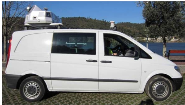
Figura 74: Vehículo dotado con el equipo OPTECH-Lynx
