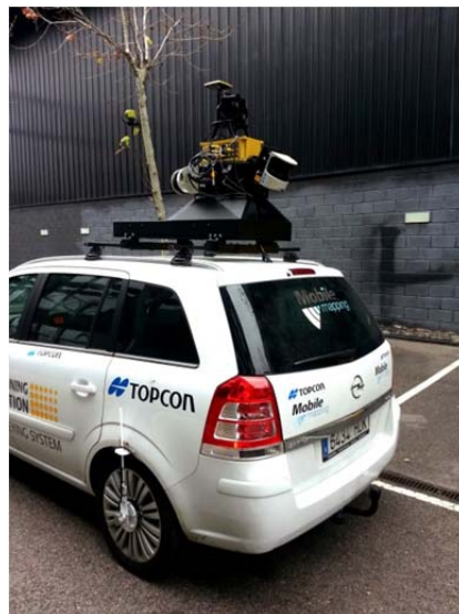
Figura 75: Vehículo dotado con el equipo IPS-2
