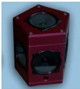
Figura 37: Sistema de cámaras digitales integrado Ladybug3 (fuente: Petrie, 2010)
