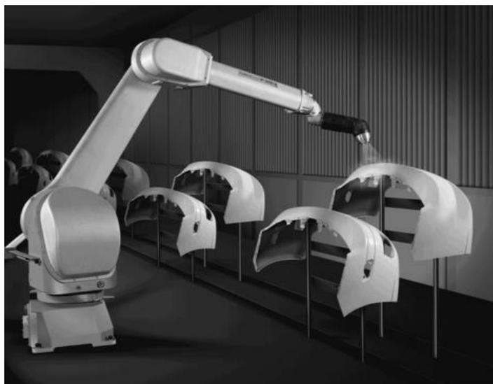
**Figura 5: Pintado de parachoques por medio de robots**
