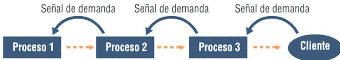
**Figura 8: Esquema de flujo de requerimientos en un sistema Pull.**
