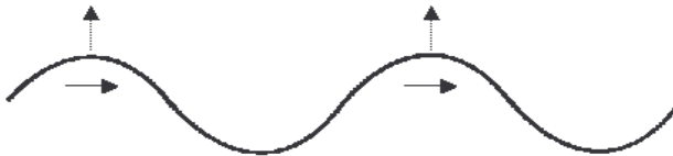
Fig. 3.8 Movimiento de una onda transversal
