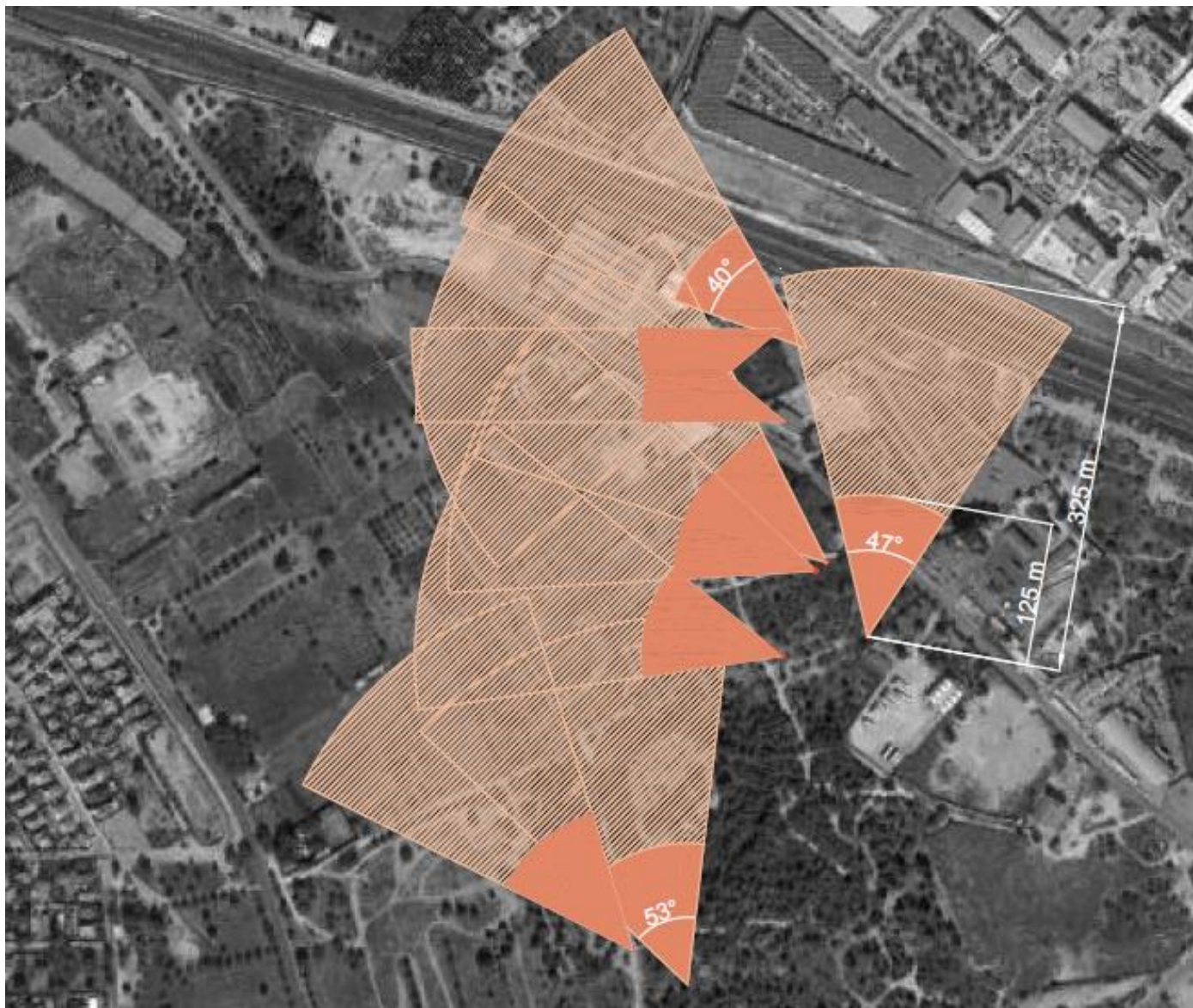
Figura 43. Esquema del área de alcance de las troneras de las casamatas que se conservan en la zona del kilómetro 11 de la carretera de Ademuz (Base cartográfica de Google Earth).
