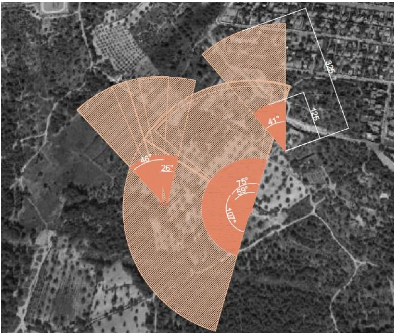
Figura 44. Esquema del área de alcance de las troneras de las casamatas que se conservan en La Vallesa (Base cartográfica de Google Earth).
