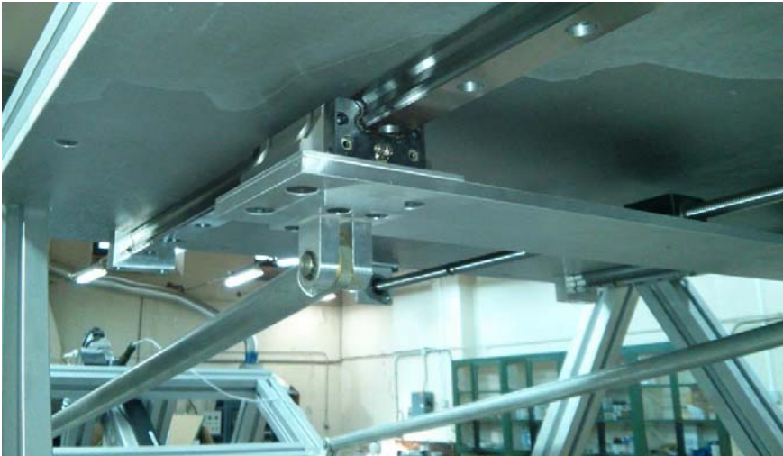
Figura 7. 4 Detalle, desde la parte posterior, del sistema de movimiento del módulo basculante mediante patines, accionado por el husillo a bolas
