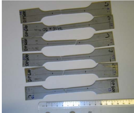
Figura 6. 5 Probetas de DP600(GM) tras los ensayos
