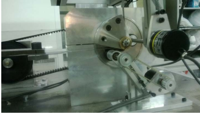
Figura 7. 10 Vista de los encoders montados sobre los balancines de aproximación
