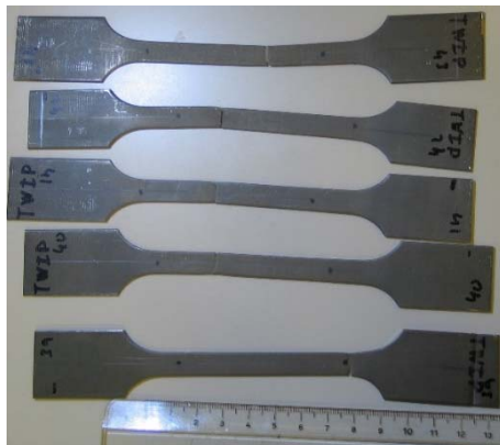
Figura 6. 9 Probetas de TWIP (POSCO) tras los ensayos
