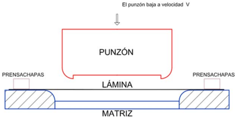
Figura 7. 15 Elementos básicos del conformado por estampación.
