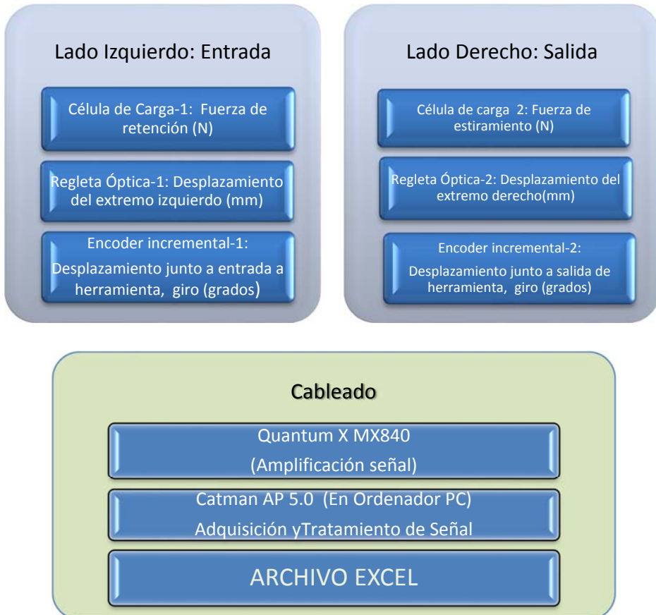
Figura 7. 14 Esquema del conjunto de medida: Transductores de ambos lados de la herramienta, Amplificación, Adquisición, tratamiento de señal y Archivo de resultados
