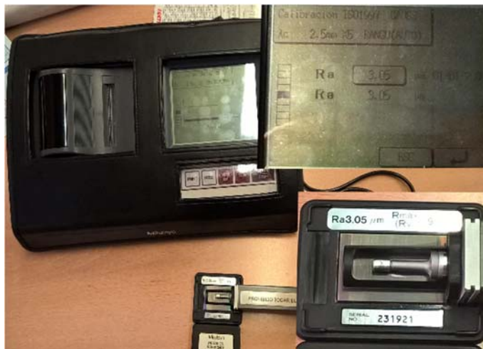
Figura 6. 16 Rugosímetro digital y el palpador sobre el patrón de verificación, en el estado de calibración que se utiliza.
