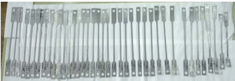
Figura 8. 5 Conjunto de probetas DP600. Pruebas iniciales
