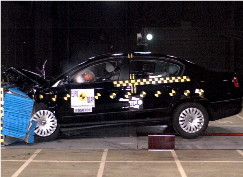
Figura 2. 10 Impacto frontal a 64 km/h contra una barrera deformable
