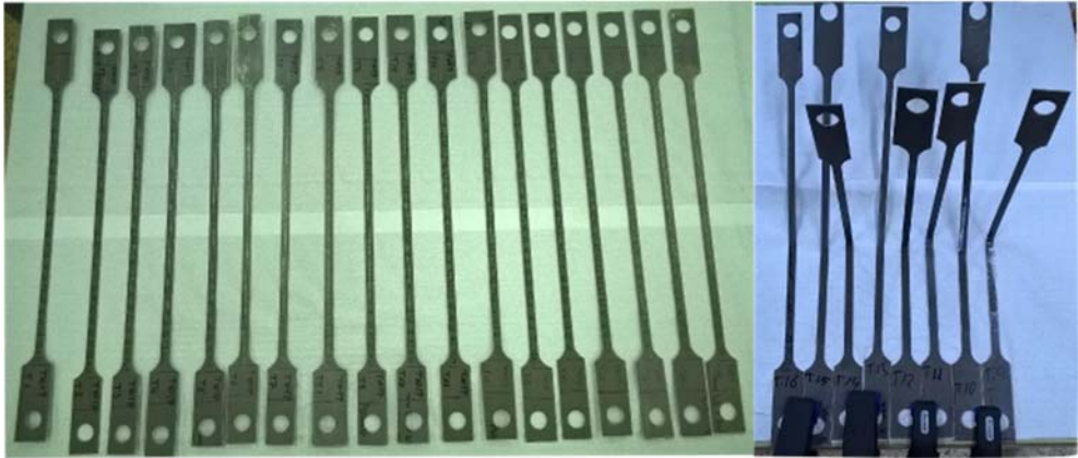
Figura 10. 2 Conjunto de probetas TWIP (GM). Antes y después de la preparación. Bloque 1
