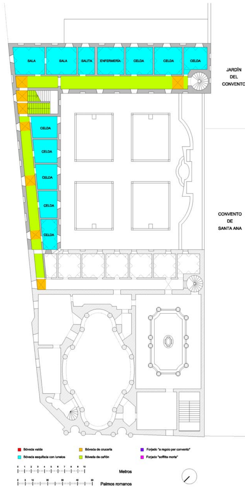
Fig. 132. Dibujo de la autora. Bóvedas y forjados de la fábrica setecentista. Planta primera.
