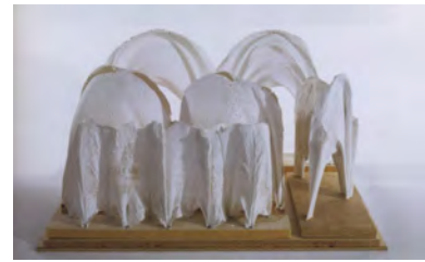
Procedimiento de estudio de la forma óptima mediante modelos de escayola, F. Otto
