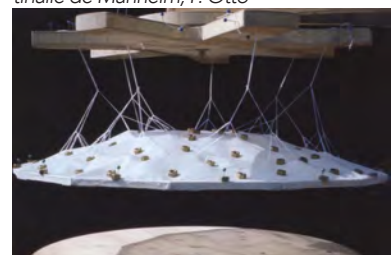
Modelo de suspensión de cadenas para análisis de cubierta arbórea de Mahilis al Shura, F. Otto
