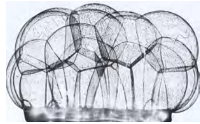
Procedimiento experimental para hallazgo de la forma estructural con películas jabonosas, F. Otto
