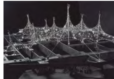
Procedimiento experimental de medición de deformaciones s/cargas mediante modelos y fotogrametría, F. Otto
