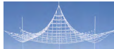
Modelo de suspensión con cadenas, F. Otto
