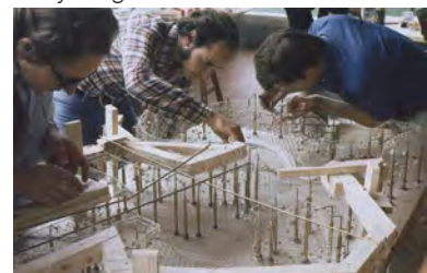
Preparación del modelo de análisis del Multhalle de Manheim, F. Otto
