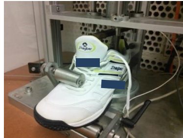
Figura 4.10. Equipo desarrollado por el IBV para la evaluación de la capacidad de amortiguación de impactos del calzado.
