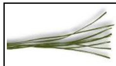
Figura 2.9. Fibra recta-monofilamento (Burillo, 2010).
