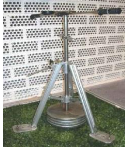
Figura 2.16. Equipo de ensayo para la evaluación de la tracción rotacional sobre superficies deportivas utilizadas con calzado de tacos.
