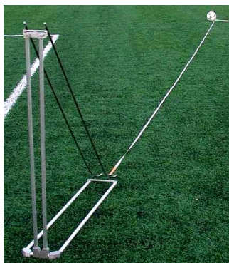
Figura 2.18. Equipo de ensayo para la evaluación de la rodadura de balón/pelota.
