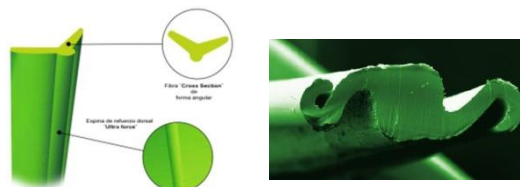
Figura 2.10. Fibra recta-monofilamento con diferentes perfiles para mejorar el efecto de memoria de forma (Burillo, 2010).
