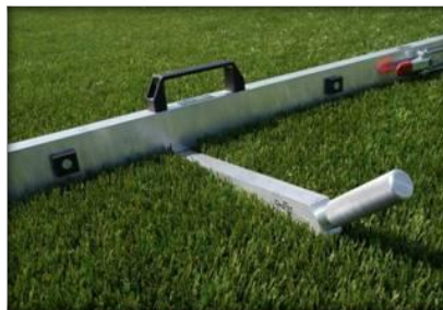
Figura 2.17. Valoración del hundimiento del campo mediante cala calibrada.
