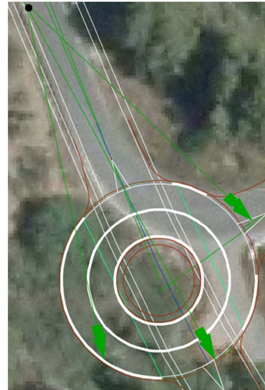
Fig. 40 Visibilidad mediante líneas de despeje desde el ramal Norte
