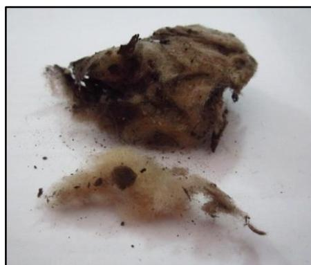
Figura 86. Muestra del aislamiento térmico, fibra de vidrio, recogido en una de las oquedades de la fachada. (Fuente: propia)
