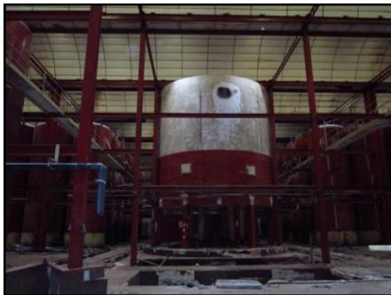
Figura 73. Fotografía actual de los bidones de obra para la refrigeración del vino.
