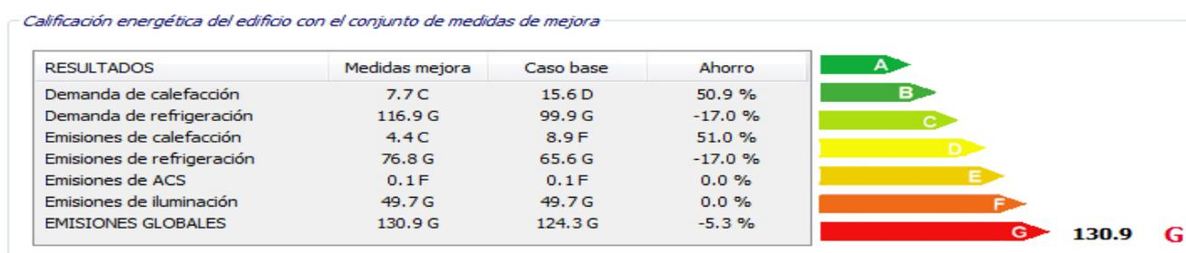
Imagen 6.4. Resultado certificación energética tras introducir las medidas de mejora del CONJUNTO 1. AISLAMIENTO TÉRMICO INTERIOR + SUSTITUCIÓN DE VENTANAS.
