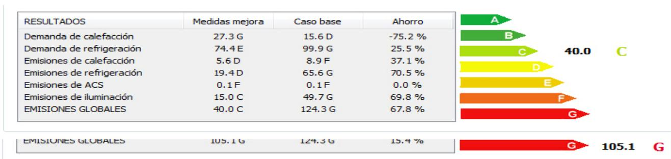
Imagen 6.7. Resultado certificación energética tras introducir las medidas de mejora del CONJUNTO 2. SUSTITUCIÓN DE LAS INSTALACIONES
