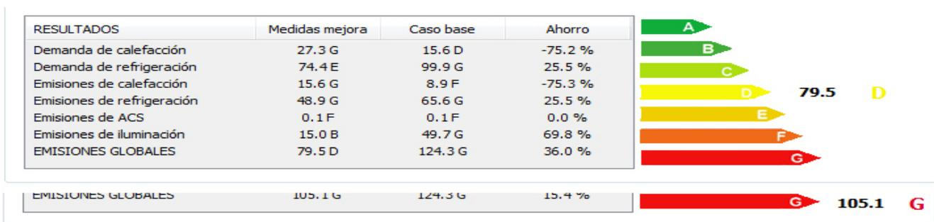
Imagen 6.6. Resultado certificación energética tras introducir la medida de mejora consistente en la SUSTITUCIÓN DEL EQUIPO DE ILUMINACIÓN.
