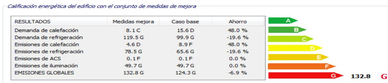
Imagen 6.1. Resultado certificación energética tras introducir la medida de mejora consistente en la incorporación de aislante térmico a la envolvente térmica por el interior.
