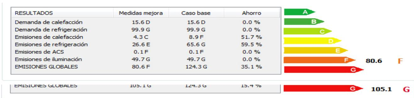
Imagen 6.5. Resultado certificación energética tras introducir la medida de mejora consistente en la SUSTITUCIÓN DEL SISTEMA DE CLIMATIZACIÓN.
