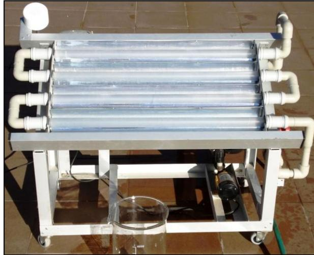
**Figura 4.29** Planta piloto de fotocatalisis solar SOLARDETOX®
