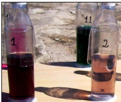
*Figura 4.26 Ensayo de fotólisis solar*
