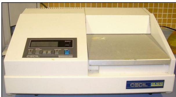
en el espectro visible (400 a 700 nm) en ciertas técnicas analíticas se realizó con un espectrofotómetro de haz simple modelo CE-1010 de CECIL Instruments, Cambridge (Reino Unido).
