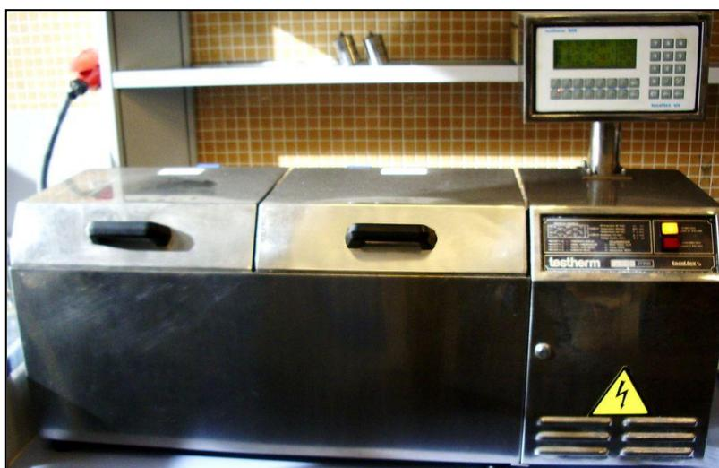
**Figura 4.33** Equipo de tintura Testtherm 90 S
