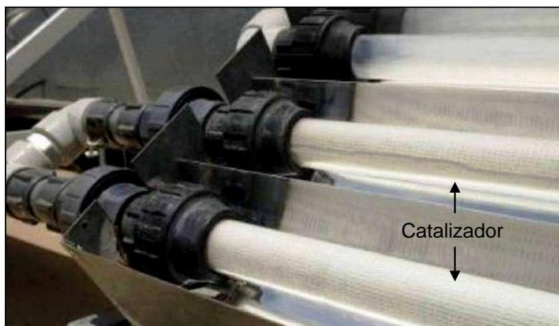
**Figura 1.16 Módulos tipo CPC y catalizador fijado**
