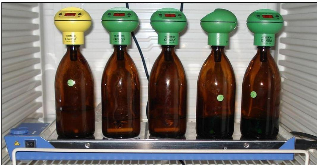
**Figura 4.22** Equipo para la determinación de la Demanda Bioquímica de Oxígeno
