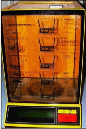
La balanza analítica electrónica empleada en las operaciones de pesada es de la marca comercial SARTORIUS A.G. (Alemania), modelo 1702 MP 8-1. Esta balanza cuenta con calibración interna y su rango de medida es de hasta 200 g, con una sensibilidad de pesada de 0.1 mg.
