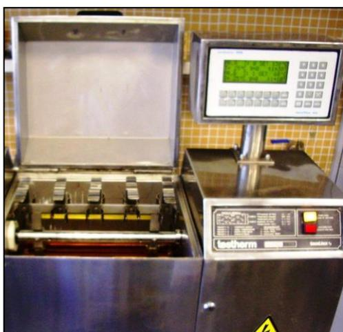
**Figura 4.34** Equipo de tintura Testtherm 90 S (detalle)
