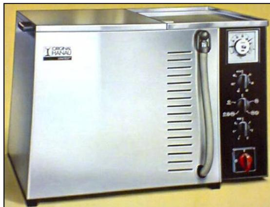
**Figura 4.36 Equipo Linitest<sup>®</sup> para la verificación de la solidez en húmedo**
