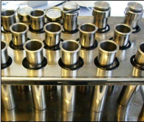
AISI 316-L con cierre hermético. Los tubos de tintura tienen unas dimensiones de 35 mm de diámetro y 200 mm de altura, con una capacidad máxima de 150 ml de baño. Este equipo asegura la máxima repetitividad de los ensayos y permite relaciones bajas de baño.
