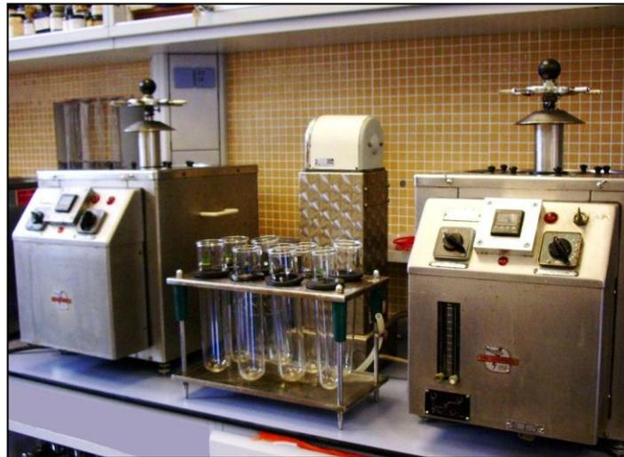
**Figura 4.32 Equipos de tintura MULTI-MAT**
