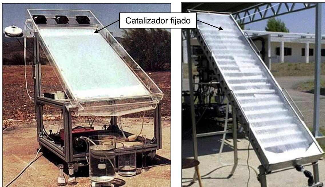
**Figura 1.8 Foto-reactores de flujo en cascada con catalizador fijado (TFFBR). Izquierda** (Bahnmann 2004), **derecha** (Malato, Blanco et al. 2007)
