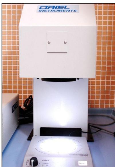
Para la realización de los tratamientos fotoquímicos en laboratorio se empleó un simulador solar Oriel Instruments, modelo 81160, de Oriel Corporation, Stratford, CT (EEUU). El espectro uniforme que emite es similar al espectro solar antes de alcanzar la tierra y tiene una potencia de  $2680 \text{ W m}^{-2}$ . Ésta equivale a la constante solar ( $1367 \text{ W m}^{-2}$ ) por 1.96, de forma que el espectro del simulador es equivalente a 1.96 veces la unidad solar.
