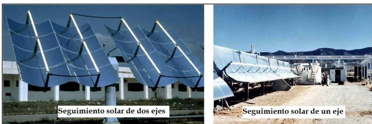
**Figura 1.7 Foto-reactores solares concentradores** (Malato, Blanco et al. 2007)
