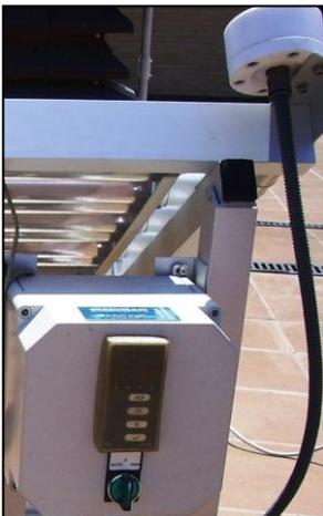
La radiación solar recibida se mide mediante un radiómetro ACADUS 85 (UV-A SOLAR) que consta de un sensor ultravioleta del tipo fotométrico: fotodiodo de Si de espectrometría de precisión, con filtro incorporado de alta calidad de banda ancha. Su rango de respuesta es entre 290 y 370 nm con pico de medición a 330 nm y atenuación 5 OD entre 400 y 1150 nm, con respuesta espacial de tipo coseno.
