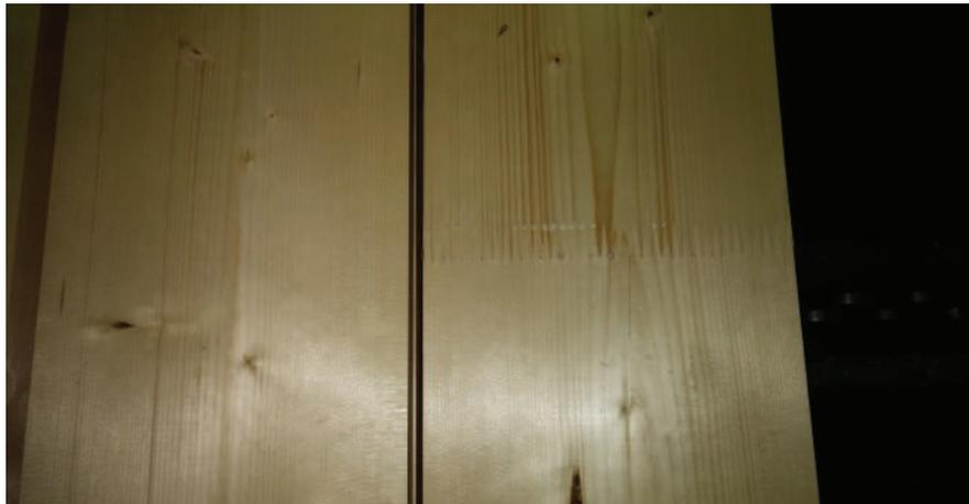
Fig. 3 - Unión en finger-joint longitudinal de las tablas. KLH massivholz GMBH.
