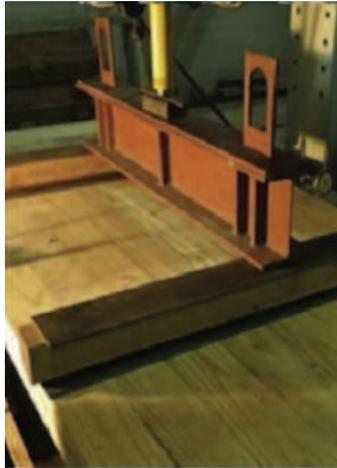
Fig. 86 - Ensayo a flexión a cuatro puntos realizado sobre madera contralaminada.
