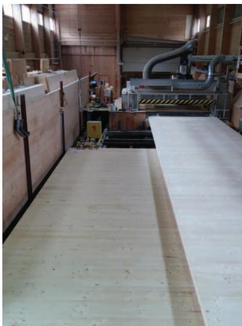
Fig. 10 - Mecanizado de los paneles mediante control numerico. KLH massivholz GMBH.
