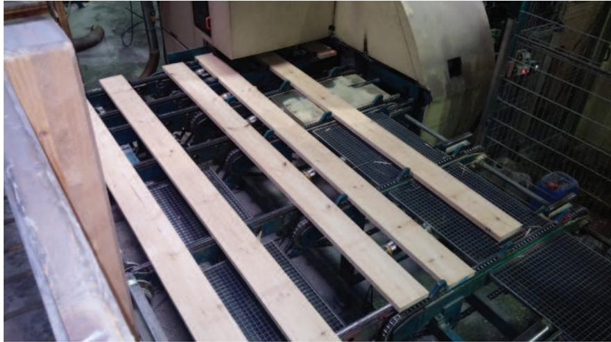
Fig. 2 - Proceso selección tablas mediante sistema láser de identificación de propiedades.
