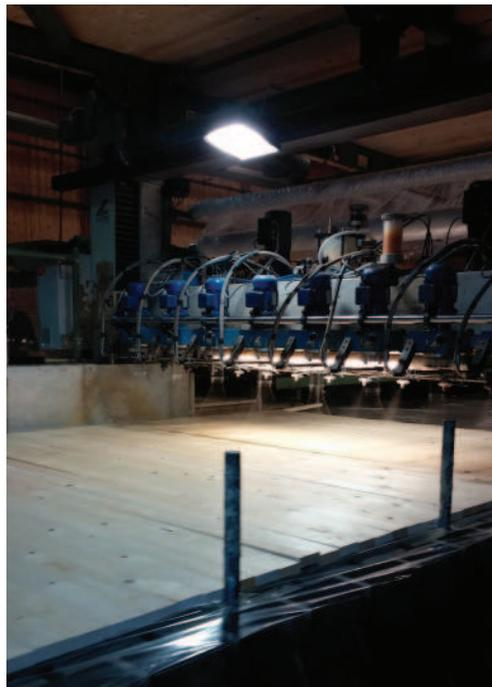
Fig. 6 - Introducción de adhesivo entre láminas. KLH massivholz GMBH.
