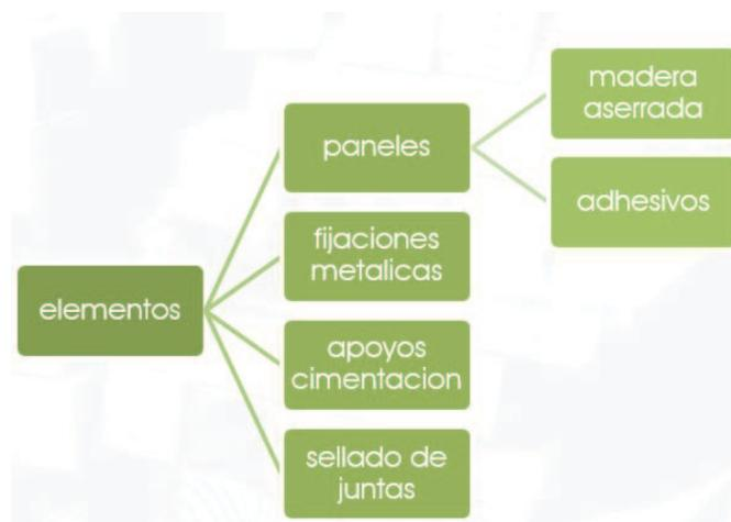
Fig. 1 - Esquema elementos constituyentes sistema madera contralaminada.
