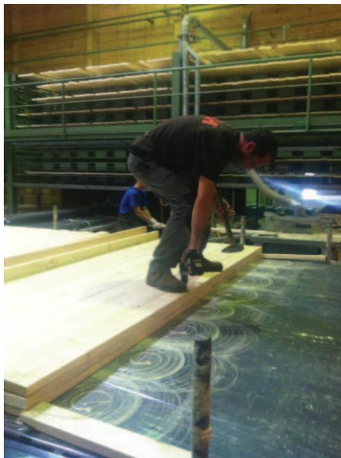
Fig. 5 - Golpeteo manual para ajuste optimo de tablas. KLH massivholz GMBH.
