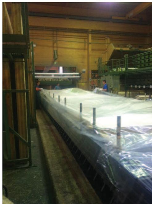
Fig. 8 - Plástico del panel para posterior secado. KLH massivholz GMBH.
