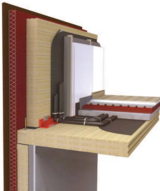
Fig. 22 - Detalle construcción de solado con instalaciones embebidas. Elaboración por el autor.
