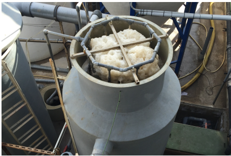
Figura 79. Separador de espuma de una granja de preengorde de la C. Valenciana.
