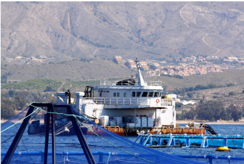
Figura 73. Plataforma de alimentación en mar abierto en una granja de la C. Valenciana.
