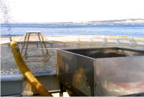
Figura 72. Cañón y tolva de alimentación en mar abierto.
