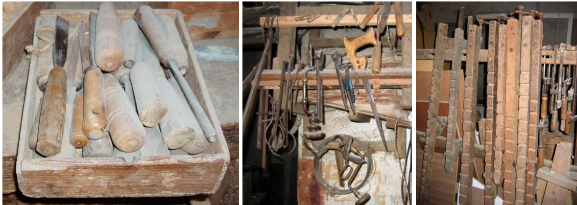
Utilatge de fusteria del taller Benet. D'esquerra a dreta: caixa de gúbies i enformadors; eines diverses (barrines, compassos, tenalles, filaberquí, serres); sergents
