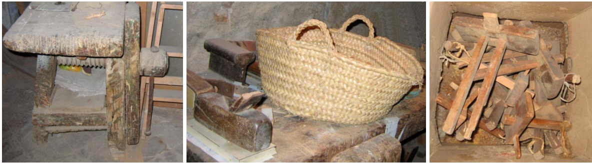
Utilatge de fusteria del taller Benet. D'esquerra a dreta: cargol de fuster; ribot, encluseta feta d'un rail de via i cabàs; rossets
