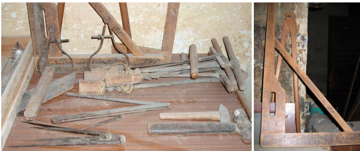
Utilatge de fusteria del taller Benet. D'esquerra a dreta: compassos de ferro, martells, escaires de fuster, barrines grans amb funda; escaire-cartabó i compàs de fusta
