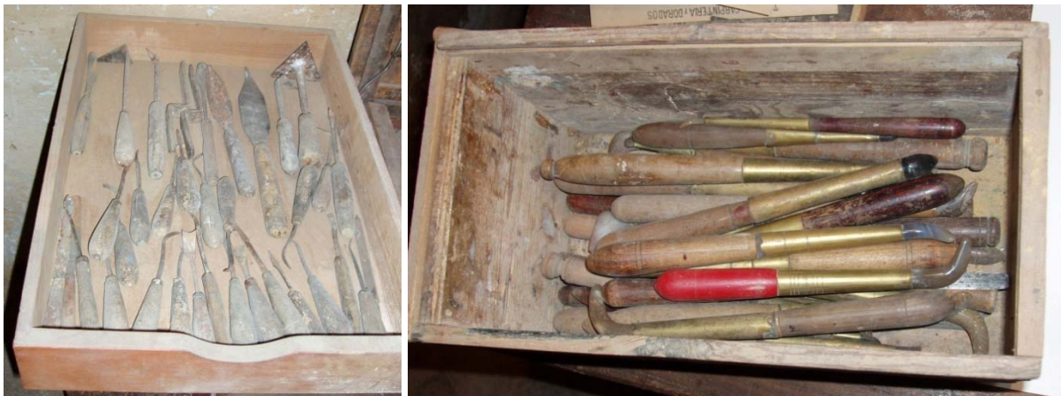
Utiltatge de daurar del taller Benet. D'esquerra a dreta: caixa amb ferros, espàtules i paletines; caixa amb brunyidors
