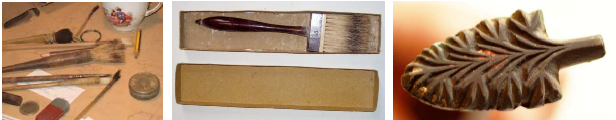
Utiltatge de daurar del taller Benet. D'esquerra a dreta: pinzells diversos; paletina amb caixa; ferro d'ornamentar
