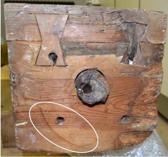
Espigues rodones de columnes a la base inferior (esquerra) i superior (dreta). Encerclada en blanc es mostra la marca del torn. (Fotografies: EADT)
