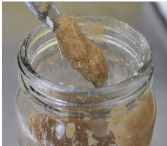
Fig. 114. Serrín mezclado con cola de conejo para la elaboración de la pasta
