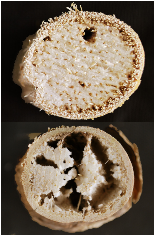
Fig. 161. y Fig. 162. Cortes transversales en los que se ve que una parte de la médula ha sido devorada por insectos
