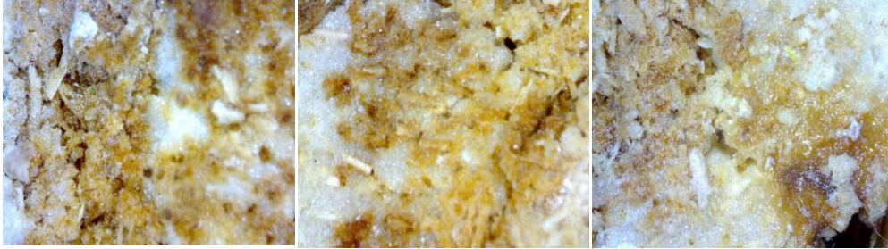
Fig. 144. Micrografía del amarilleamiento de las fibras internas de las médulas y aglutinantes de la probeta M7HT-C2. 15-10X.
