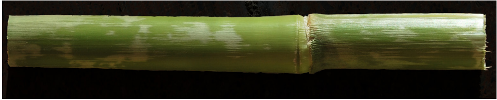
Fig. 151. Caña fresca, recién cortada. En este estado es cuando el material contiene más cantidad de agua.
