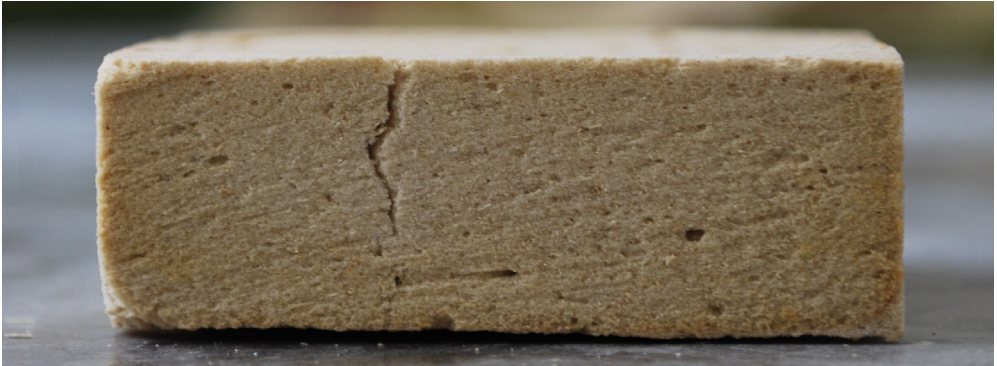
Fig. 165. Corte de pasta de caña de maíz donde se observa la sección de una grieta
