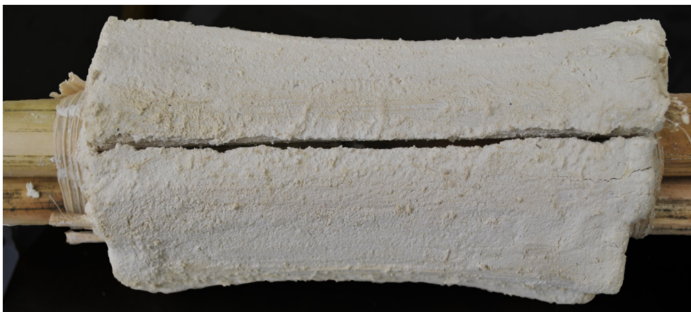
Fig. 168. Abertura transversal de la pasta de caña
