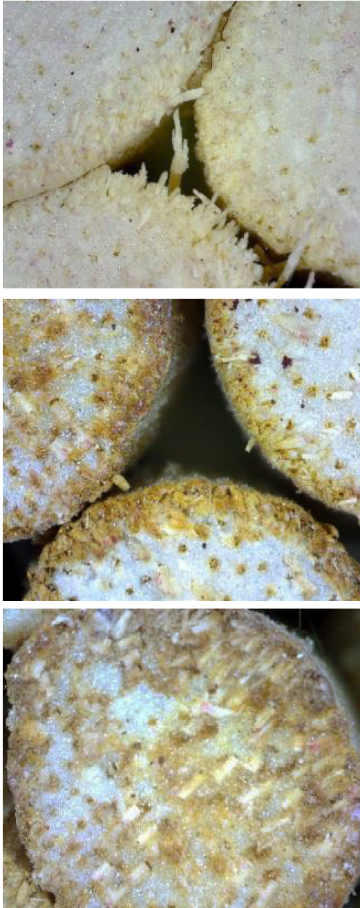
Fig. 148. Micrografías de cañas antes de someterse al calor (izquierda) y cañas amarillentas tras ser envejecidas con calor seco (derecha). 15-10X.
