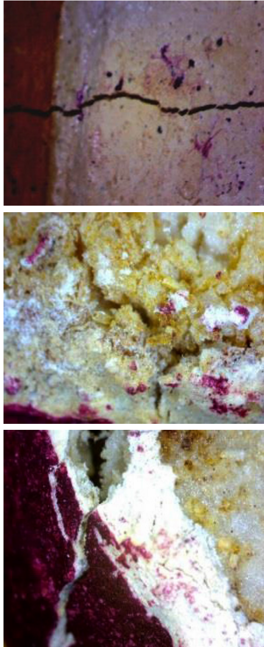
Fig. 147. Micrografías de fisuras en la superficie de la capa pictórica de la probeta de pasta delgada M10T-C2 (arriba), y separación de estratos en los bordes de la probeta de pasta gruesa M3T-B1 (abajo). 15-10X.
