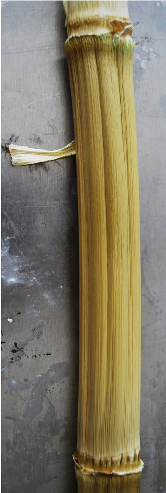
Fig. 156. Caña seca con encogimiento hacia el interior y alabeamiento
