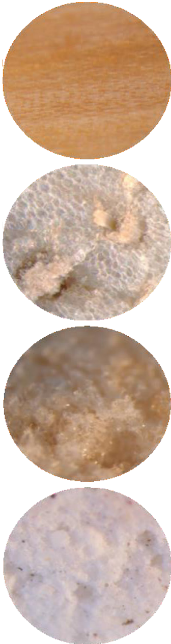
Fig. 130. Fotografías microscópicas de la corteza de la caña de maíz, la médula, la pasta y del aparejo respectivamente en las que se observa la porosidad
