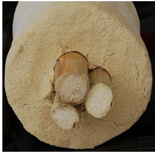
Fig. 167. Separación de la pasta de la estructura central compuesta por cañas enteras
