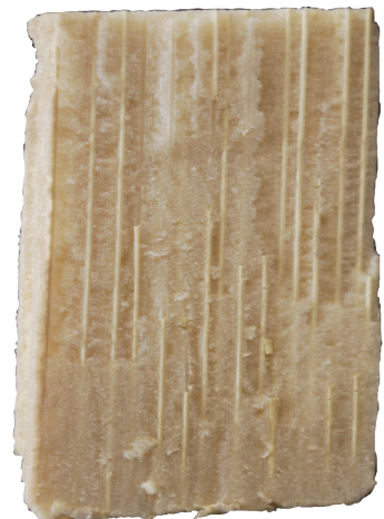
Fig. 87. Fotografía macro de la médula de la caña de maíz. Corte longitudinal
