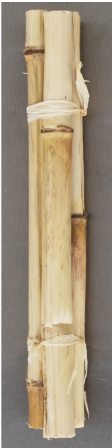
Fig. 118. Ejemplo de la estructura interna empleada en las probetas
