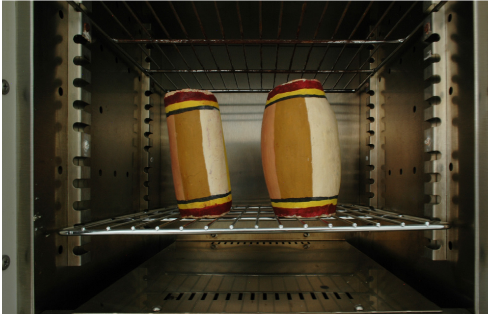
Fig. 138. Probetas en el interior de la cámara de temperatura alta controlada
