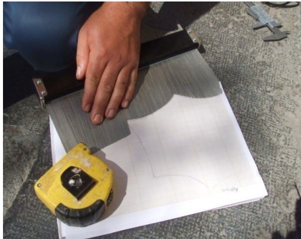
Imagen 5 RESULTADOS DEL LEVANTAMIENTO CON EL PERFILÓMETRO
