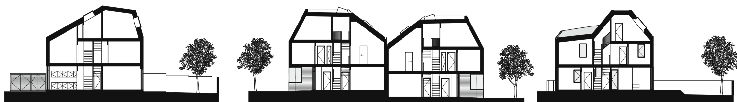
3.100_Secciones de las viviendas de Newhall, desarrolladas por Alison and Brooks Architects
