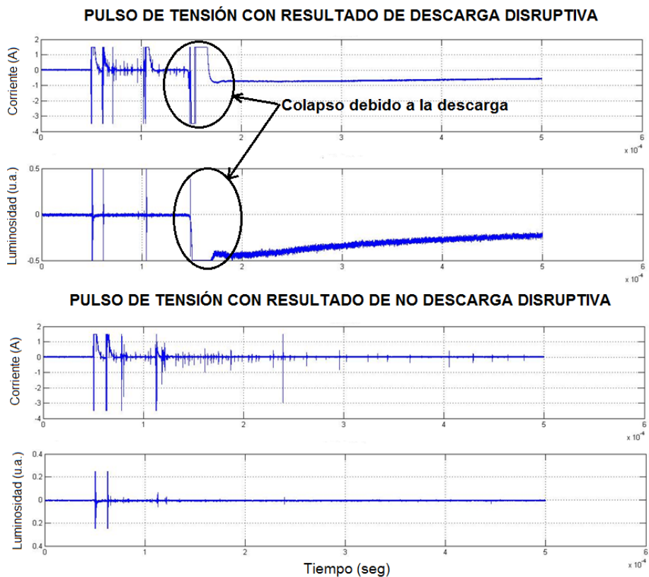
Figura 3.6. Se puede identificar muy fácilmente el resultado del impulso identificando si existe colapso de la corriente o la fotoemisión.
