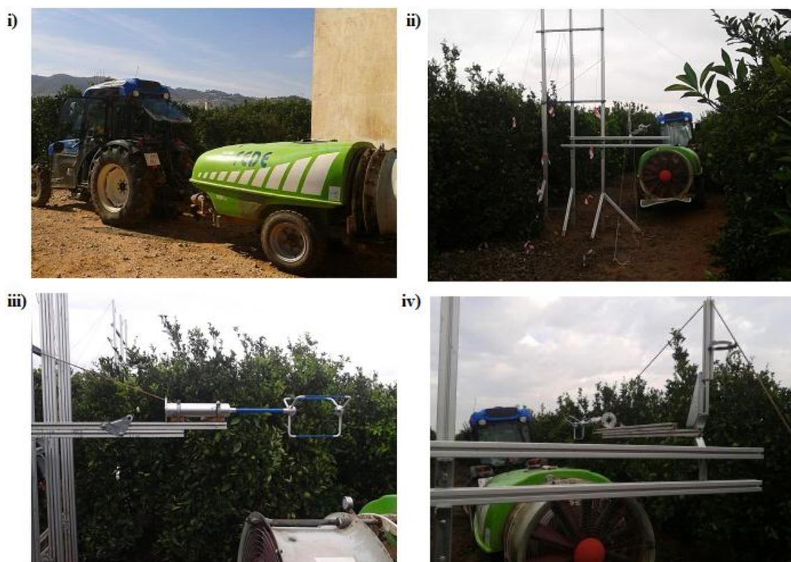
*Figura 53. En la imagen (i) se muestra el equipo empleado para los ensayos de esta tesis. En la imagen (ii) se muestra el equipo en posición frente al árbol junto a los postes de medida antes del árbol. En la imagen (iii) se muestra el anemómetro, que se deslizaba a lo largo de los postes. También se ven los postes al otro lado del árbol. En la imagen (iv), aparece el único poste horizontal del ensayo sobre el ventilador.*
