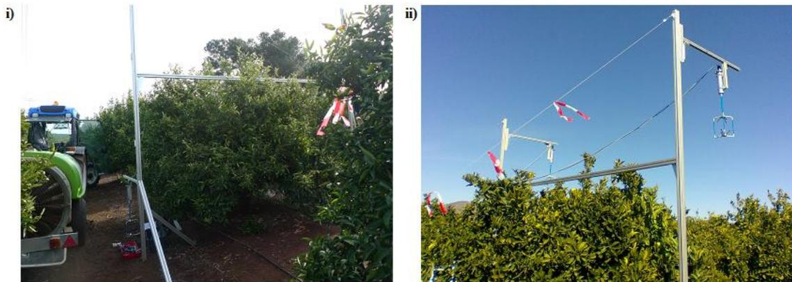
*Figura 54. La imagen (i) enseña al equipo en posición midiendo las velocidades antes del árbol en el poste C. La imagen (ii) muestra los dos anemómetros en posición en los postes C y D.*
