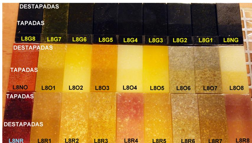
**Figura 7.181:** Fotografía de las muestras al finalizar el ensayo de envejecimiento acelerado en la cámara climática SolarBox1500e para las muestras de resina con los tres colorantes naturales NG, NR y NO, y los nanopigmentos sintetizados en las condiciones del experimental L8 (al 5 % para NG, y 10 % con NO y NR).
