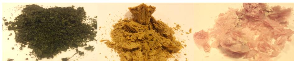
**Figura 6.5:** Fotografía de tres ejemplos de nanopigmentos con montmorillonita en polvo secos, en los que se observan los agregados en forma de láminas.
