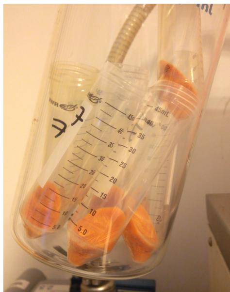
**Figura 6.4:** Fotografía pastas de nanopigmento secándose en el liofilizador.
