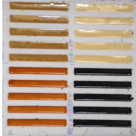
**Figura 6.16:** Fotografía del molde de silicona rígido, con muestras de resina GP55 con diferentes materias incorporadas.
