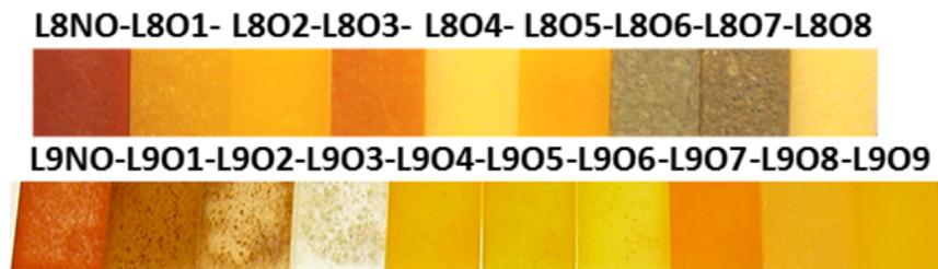
**Figura 7.151:** Fotografía de las resinas curadas con el 10% arriba (L8) y 5% bajo (L9) del colorante natural NO, y los materiales compuestos generados a partir de los experimentales L8 y L9, respectivamente.
