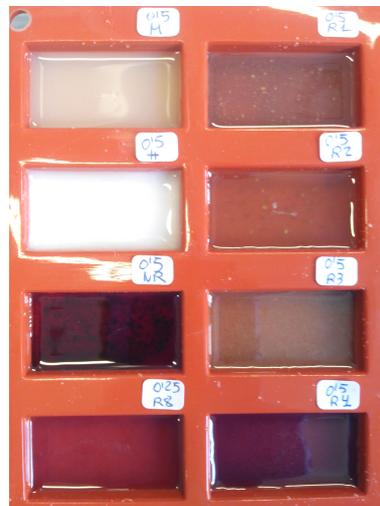
**Figura 6.17:** Fotografía del molde de silicona blando, con muestras de resina GP55 con diferentes materias incorporadas.
