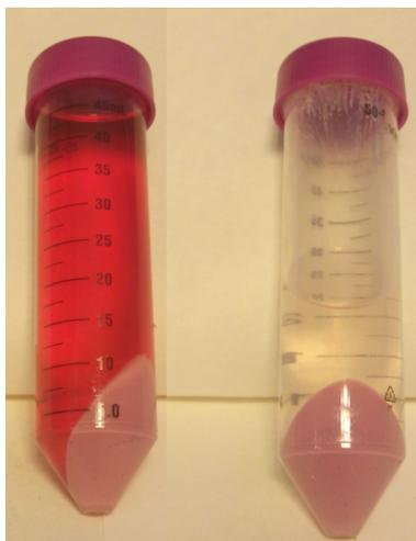
**Figura 6.3:** Fotografía de una muestra en la primera centrifugada, con el sobrenadante coloreado, y después del lavado, con el sobrenadante limpio.
