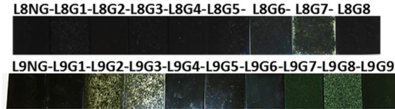
**Figura 7.144:** Fotografía de las resinas curadas con el 5% del colorante natural NG, y los materiales compuestos generados a partir de los experimentales L8 y L9.
