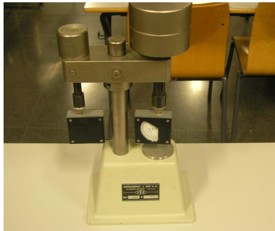
**Figura 5.10:** Fotografía del durómetro modelo 673-D.
