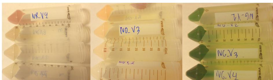
**Figura 6.13:** Fotografía del resultado en pasta de nanopigmentos de montmorillonita con las pruebas de concentración de los tres colorantes naturales.
