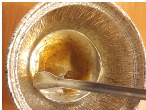
**Figura 6.15:** Fotografía durante la mezcla de la resina GP55 con un nanopigmento.
