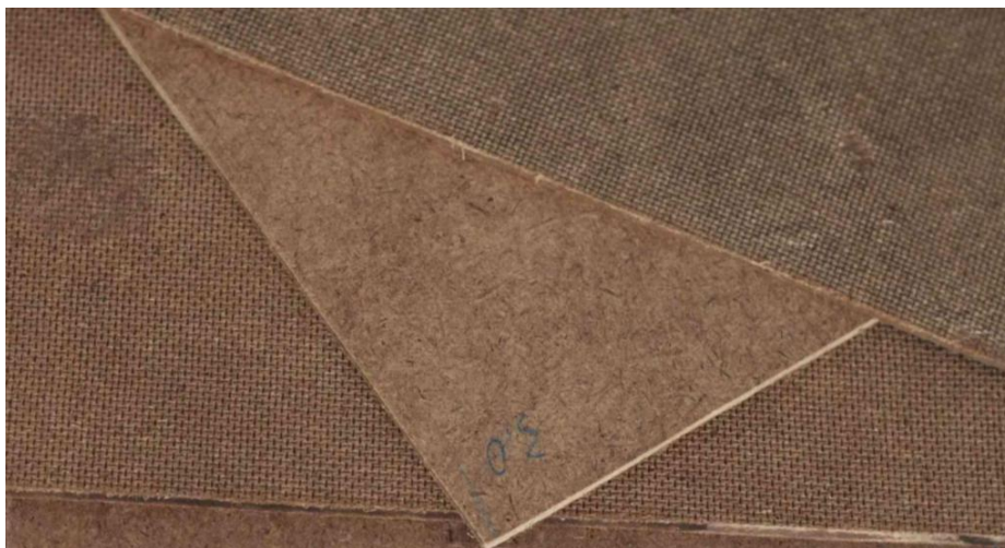
Figura 1.5.5. Tableros de fibra duro por el anverso y por el reverso.
