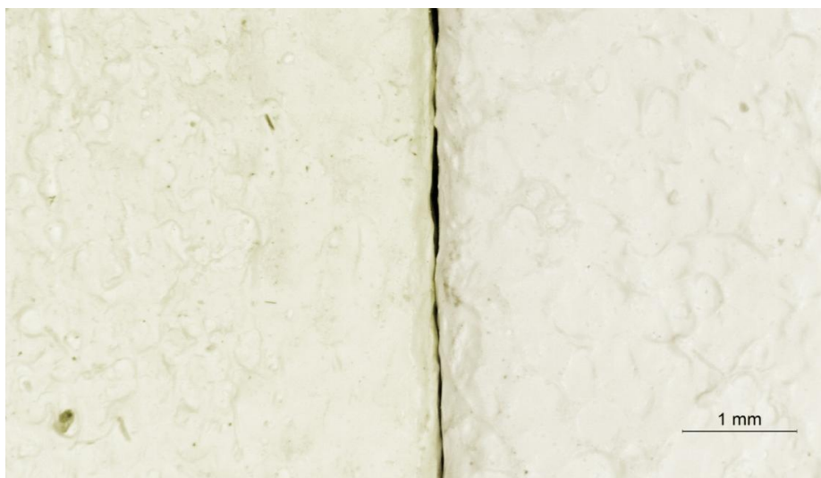
Figura 5.4.9. Imagen obtenida mediante lupa binocular 10x. A la izquierda probeta Lb1-X después de una exposición de 800 horas a la luz de lámparas de arco de xenón. A la derecha probeta Lb0-X (PCI).
