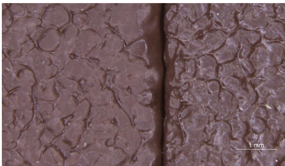
Figura 5.4.44. Imagen obtenida mediante lupa binocular (10x). A la izquierda de la imagen, la probeta Gs02C-UVA después de una exposición de 800 horas a la luz de lámparas UVA-351. A la derecha probeta Gs00-UVA (PCI).
