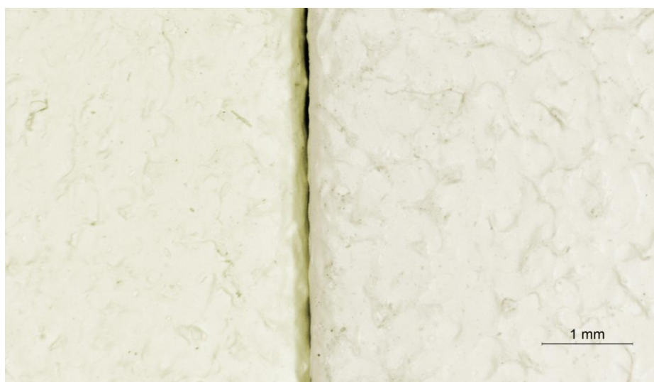
Figura 5.4.34. Imagen obtenida mediante lupa binocular (10x). A la izquierda de la imagen, probeta Lb10C-UV después de una exposición de 800 horas a la luz de lámparas UVB-313. A la derecha, probeta Lb00-UV (PCI).
