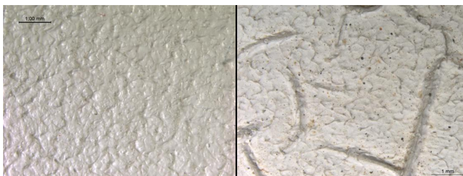
Figura 5.4.61. Imágenes obtenidas mediante lupa binocular (10x). A la izquierda de la imagen, la probeta La00R y a la derecha la probeta La09R después de un año de exposición a la intemperie.
