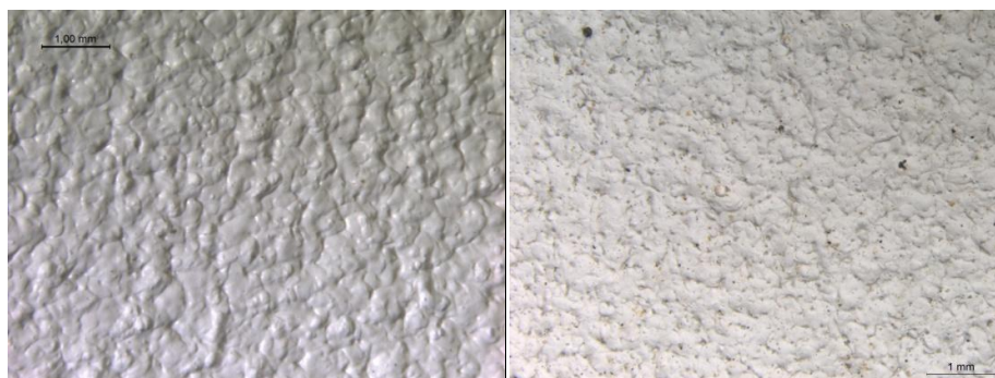
Figura 5.4.58. Imágenes obtenidas mediante lupa binocular (10x). A la izquierda de la imagen, la probeta Gb00R y a la derecha la probeta Gb07R después de un año de exposición a la intemperie.
