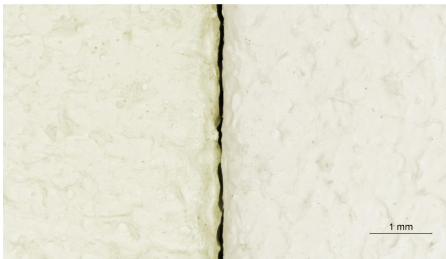
Figura 5.4.18. Imagen obtenida mediante lupa binocular 10x. A la izquierda probeta b1-X después de una exposición de 800 horas a la luz de lámparas de arco de xenón. A la derecha probeta b0-X (PCI).
