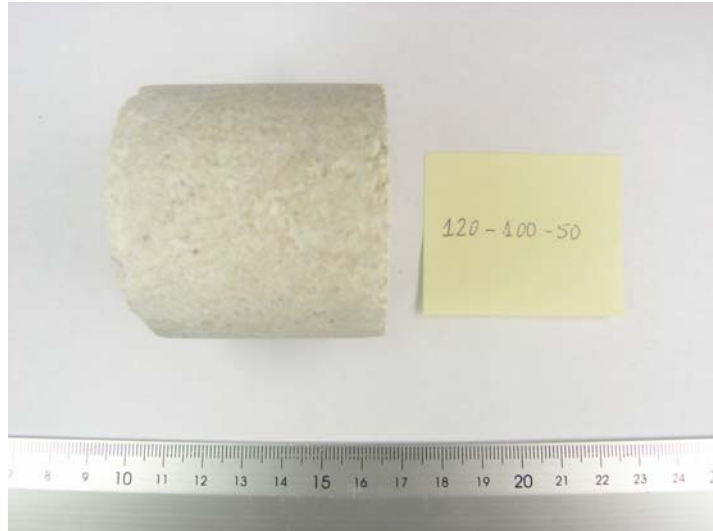
Figura A.29.- V2 120-100-50, 50 mm, humectada, sin porosidad, analizada en estudio preliminar.
