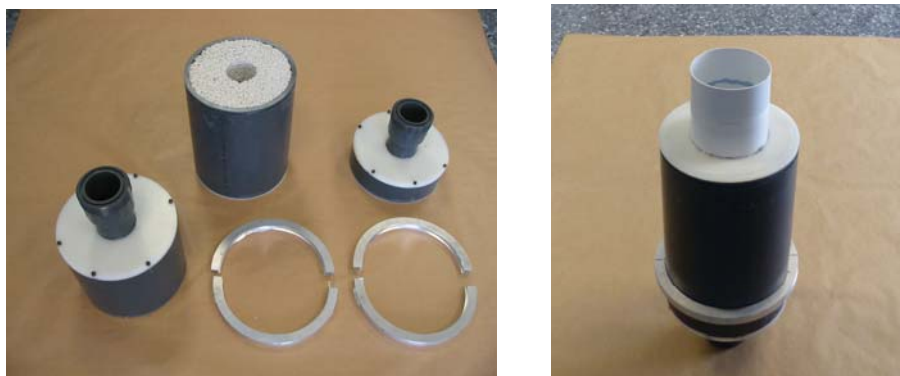
Figura 6.17.- Utillaje para montaje y detalle del silenciador con tubo extendido y anillo externo.
