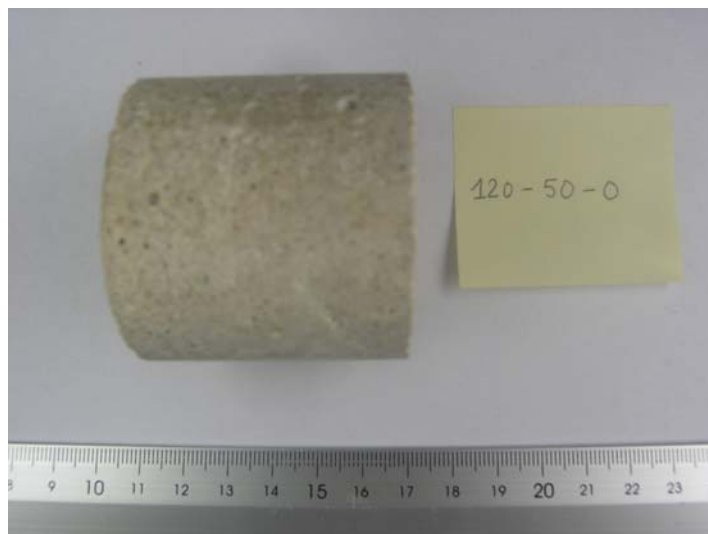
Figura A.32.- V2 120-50-0, 50 mm, humectada, con porosidad, analizada en estudio preliminar.
