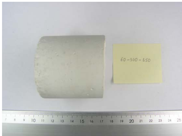
Figura A.28.- V2 60-300-150, 50 mm, humectada, sin porosidad, analizada en estudio preliminar.
