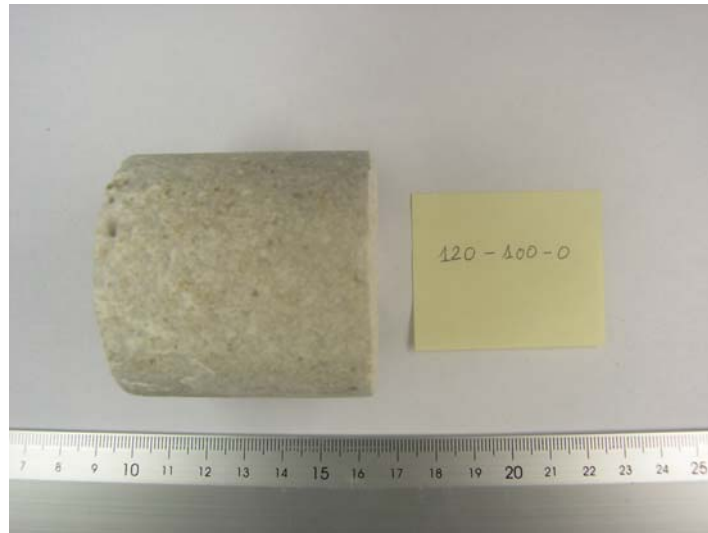
Figura A.31.- V2 120-100-0, 50 mm, humectada, sin porosidad, analizada en estudio preliminar.
