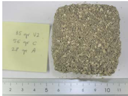
Figura 5.11.- Probeta V2 35-56-28 con cemento habitual de baja resistencia.
