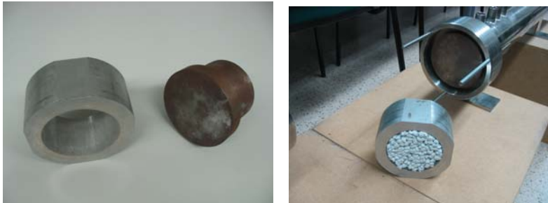
Figura 5.49.- Portamuestras fabricado en aluminio y terminación rígida.
