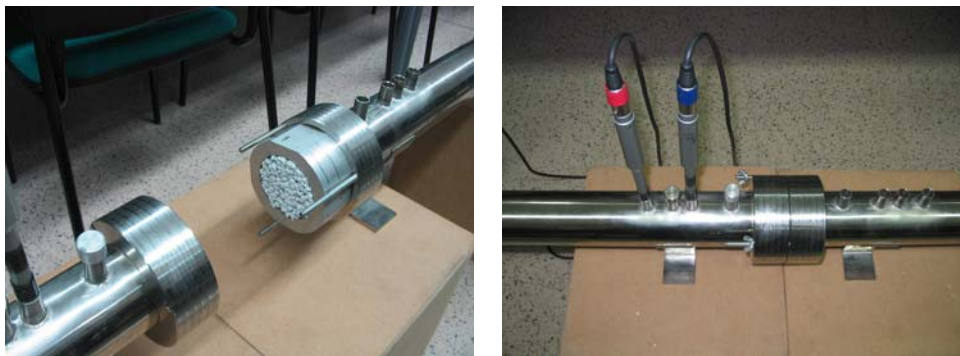
Figura 5.50.- Detalle del montaje del portamuestras y micrófonos.
