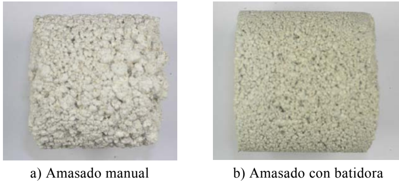
Figura 5.16.- Diferencia entre amasado manual y mecánico en V2 20-80-64.
