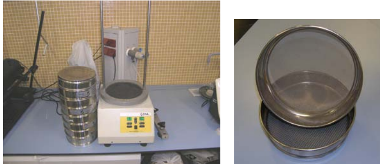
Figura 5.1.- Tamizadora disponible en el laboratorio. Tamices según norma UNE 7050-3 [282].
