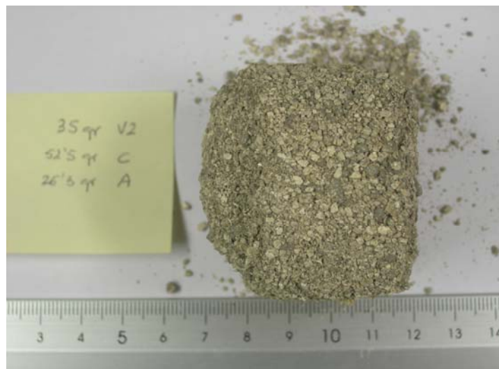
Figura A.2.- V2 35-51.5-26.3. Cemento 32.5 R, 50 mm, baja consistencia.
