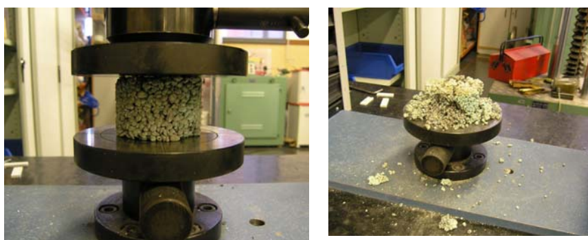
Figura 5.108.- Ejemplo de ensayo de compresión en muestra caracterizada.
