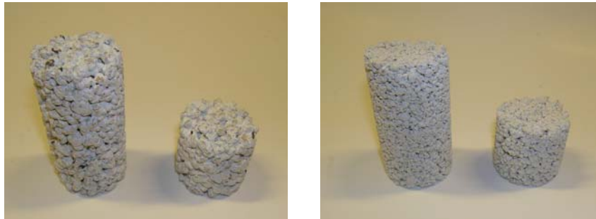
Figura 6.3.- Probetas de Arl_gruesa y V3 para determinar la impedancia característica y el número de onda.
