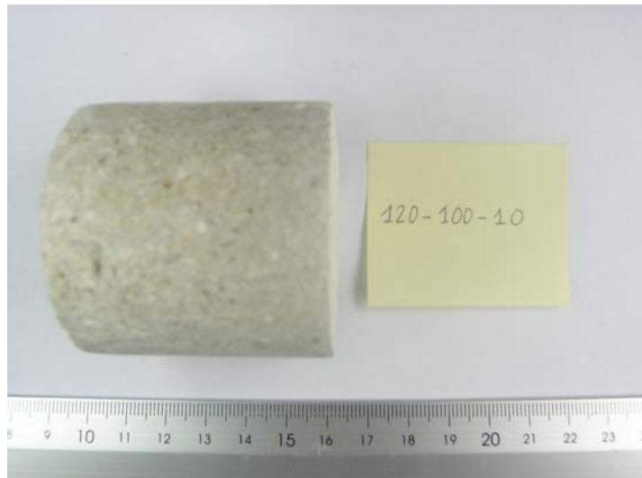
Figura A.30.- V2 120-100-10, 50 mm, humectada, sin porosidad, analizada en estudio preliminar.
