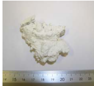
Figura 5.19.- Apelmazamiento de varios granos por exceso de agua.
