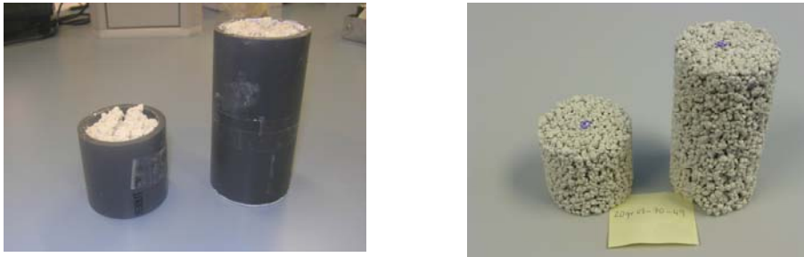
Figura 5.10.- Molde de preparación y probetas extraídas.
