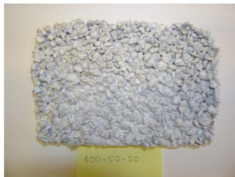
Figura 5.23.- Probeta de arlita con cohesión y sin porosidad Arl 100-50-50.
