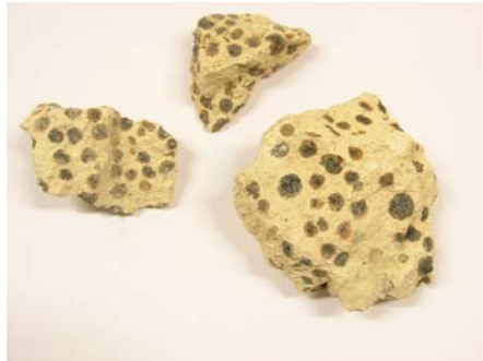
Figura 4.3.- Mortero de cemento aligerado con arlita. Material obtenido de restos en reforma de vivienda.
