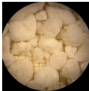
Figura 4.4.- Foto de perlita en microscopio óptico (x16).
