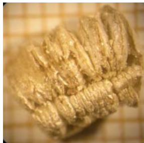
Figura 4.6.- Láminas exfoliadas en vermiculita Tipo 3 (x20).
