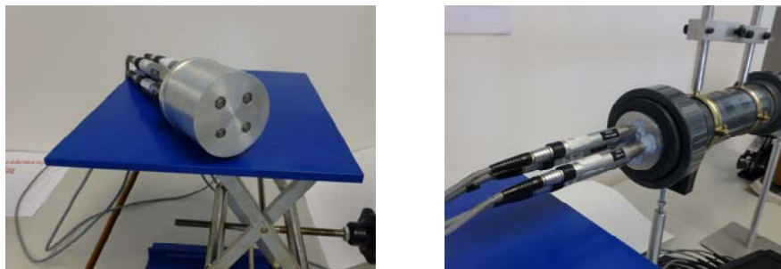
Figura 6.6.- Montaje para calibración de los micrófonos.
