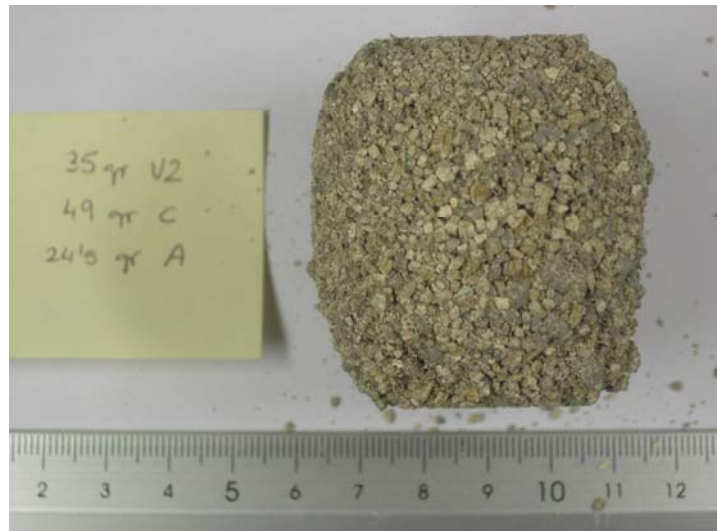
Figura A.1.- V2 35-49-24.5. Cemento 32.5 R, 50 mm, baja consistencia.
