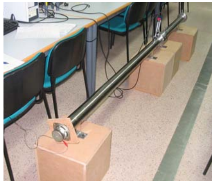
Figura 5.48.- Ensayo en tubo de impedancia.
