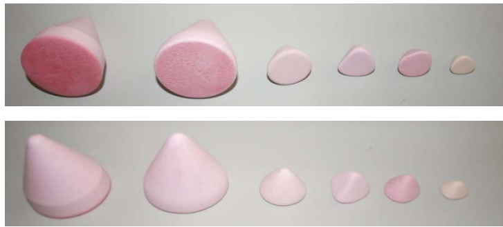
Figura 42. Detalle desgaste paulatino moletas de urea.
