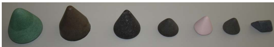
Figura 41. Detalle moletas poliéster, urea y cerámicas.
