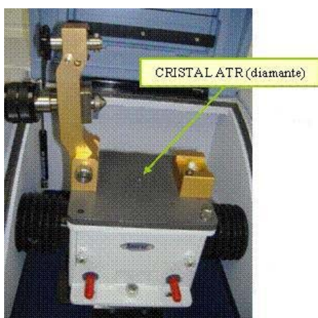
Figura 48. Espectrómetro por transformada de Fourier Nicolet 6700 FTIR. Detalle accesorio de reflectancia total atenuada (ATR) de reflexión en un punto.
