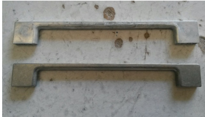
Figura 37. Detalle piezas inyectadas antes y después del vibrado.
