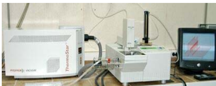
Figura 56. Equipo simultáneo TG-DTA / EM.
