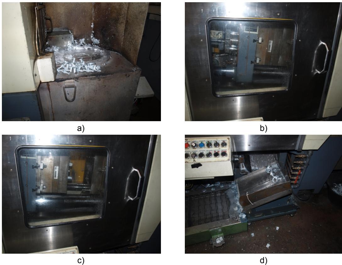
Figura 36. Detalle proceso fundición e inyección: a) crisol de fundición, b) inyección y cierre de molde, c) refrigeración pieza moldeada y d) extracción pieza inyectada.
