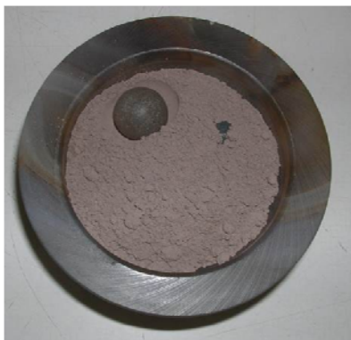
Figura 81. Homogeneización en molino planetario.
