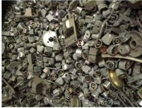
Figura 44. Mezcla piezas defectuosas con y sin recubrimiento final.
