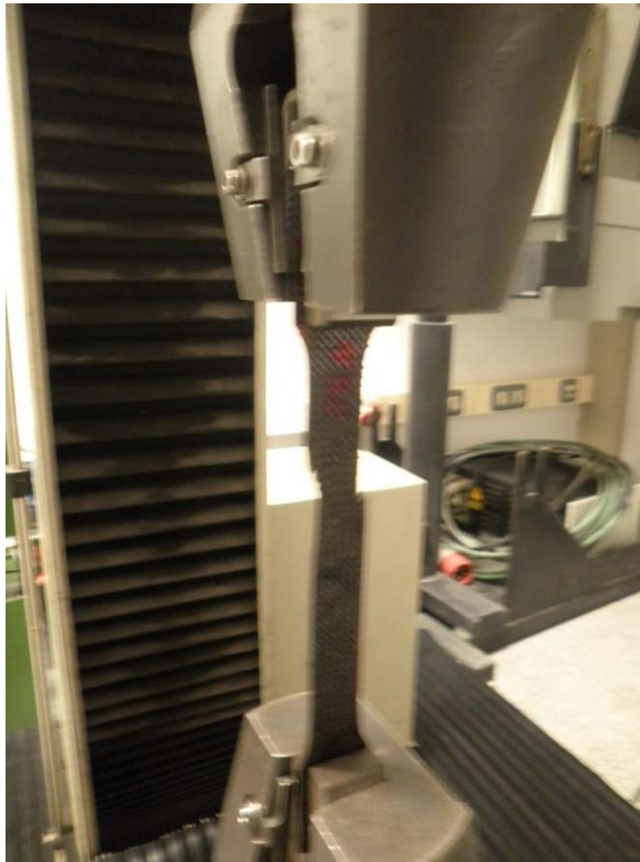
Figura 74b. Máquina de tracción y extensómetro en funcionamiento.
