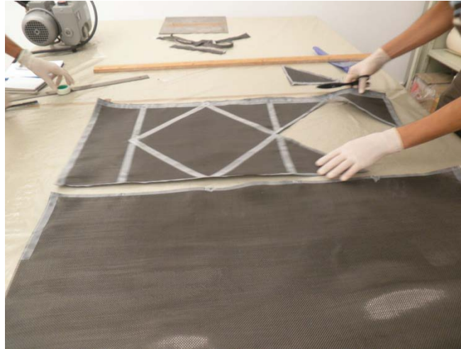
Figura 40. Bobina marcada con cinta adhesiva cuadrados 30 x 30, orientación de la fibra 45°.
