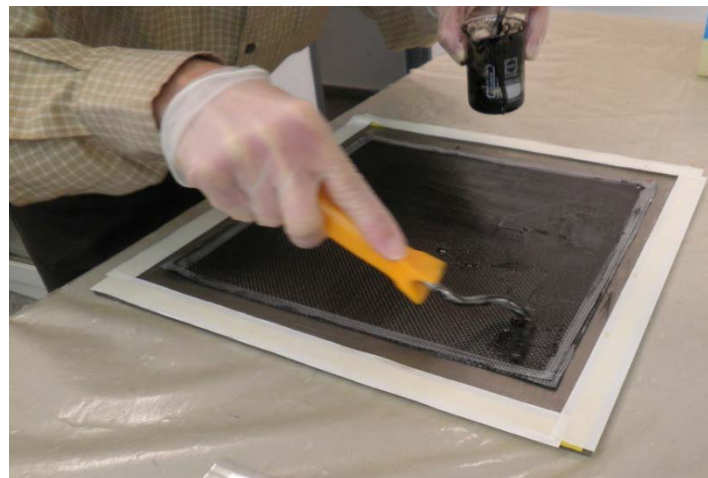
Figura 89. Dispersión de la resina epoxi.
