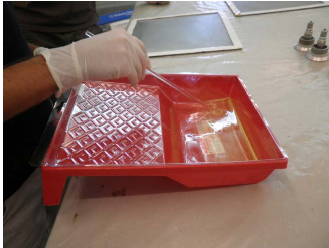
Figura 42. Mezcla matriz epoxi, del proveedor Jose Antonio Garcia, C/ Cardenal Benlloch 44 Valencia.
