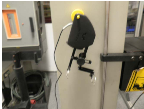
Figura 73. Extensómetro del 1r piso del departamento de mecánica y materiales de la UPV.
