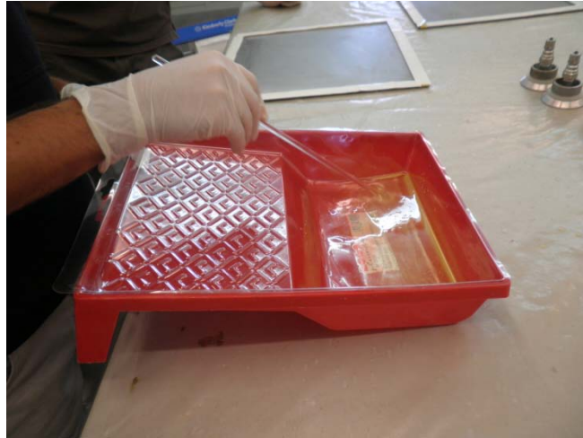
• Figura 42. Mezcla matriz epoxi, Araldite LY 3505/Hardener XB 3404. Del proveedor Jose Antonio Garcia, C/ Cardenal Benlloch 44 Valencia.
