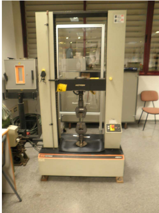
Figura 49. Máquina de tracción ISNTRON 4202 con una célula de carga de 50KN del 1r piso del departamento de mecánica y materiales de la UPV.
