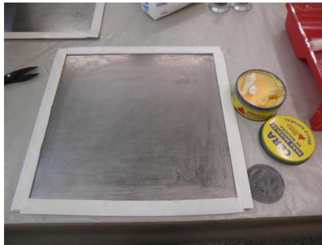
Figura 65. Molde encerado y cera Promade S.L.
