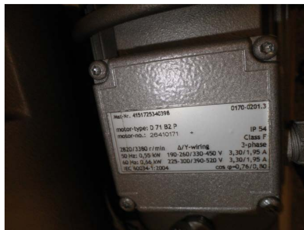
Figura 67. Especificaciones bomba de vacío.
