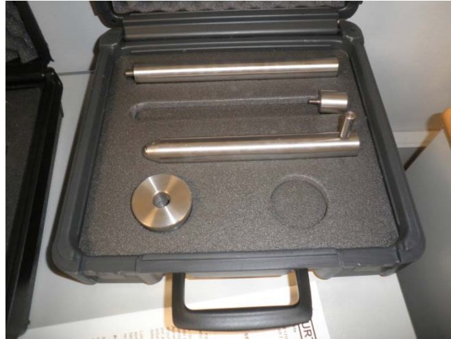
Figura 82. Pesos y complementos, máquina de impacto NEURTEC de 1m de longitud, del 1r piso del departamento de mecánica y materiales de la UPV.
