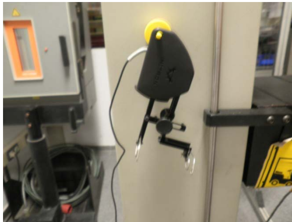
Figura 50. Extensómetro del 1r piso del departamento de mecánica y materiales de la UPV.
