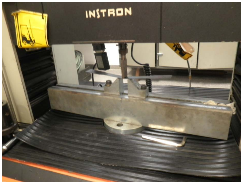
Figura 83. Complemento de flexión de la máquina INSTRON con 1KN Célula de carga, del 1r piso del departamento de mecánica y materiales de la UPV.
