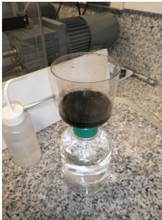
Figura 39. Filtrado de grafeno.
