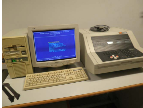
Figura 31: Ordenador y consola de la máquina de tracción ISNTRON 4202.
