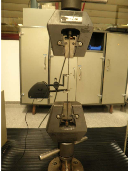
Figura 74. Máquina de tracción y extensómetro en funcionamiento.
