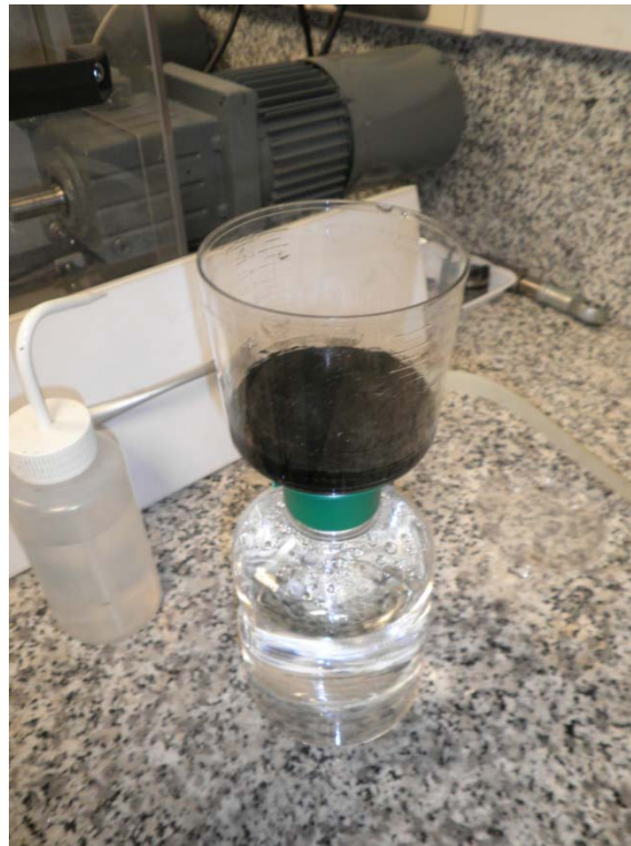
Figura 39. Filtrado de grafeno.
