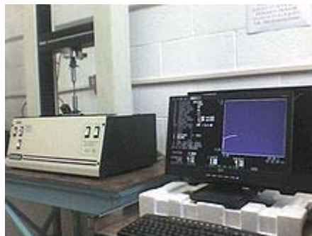
Figura 32. Máquina para ensayo de tracción por computadora.
