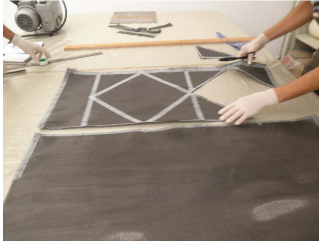
Figura 63. Bobina marcada con cinta adhesiva cuadrados 30 x 30, orientación de la fibra 45°.
