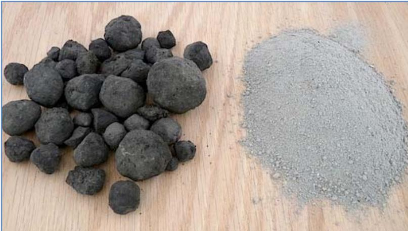
**Figura 2.4. Fragmentos de clínker y producto final tras la molienda y adiciones: el cemento.**
